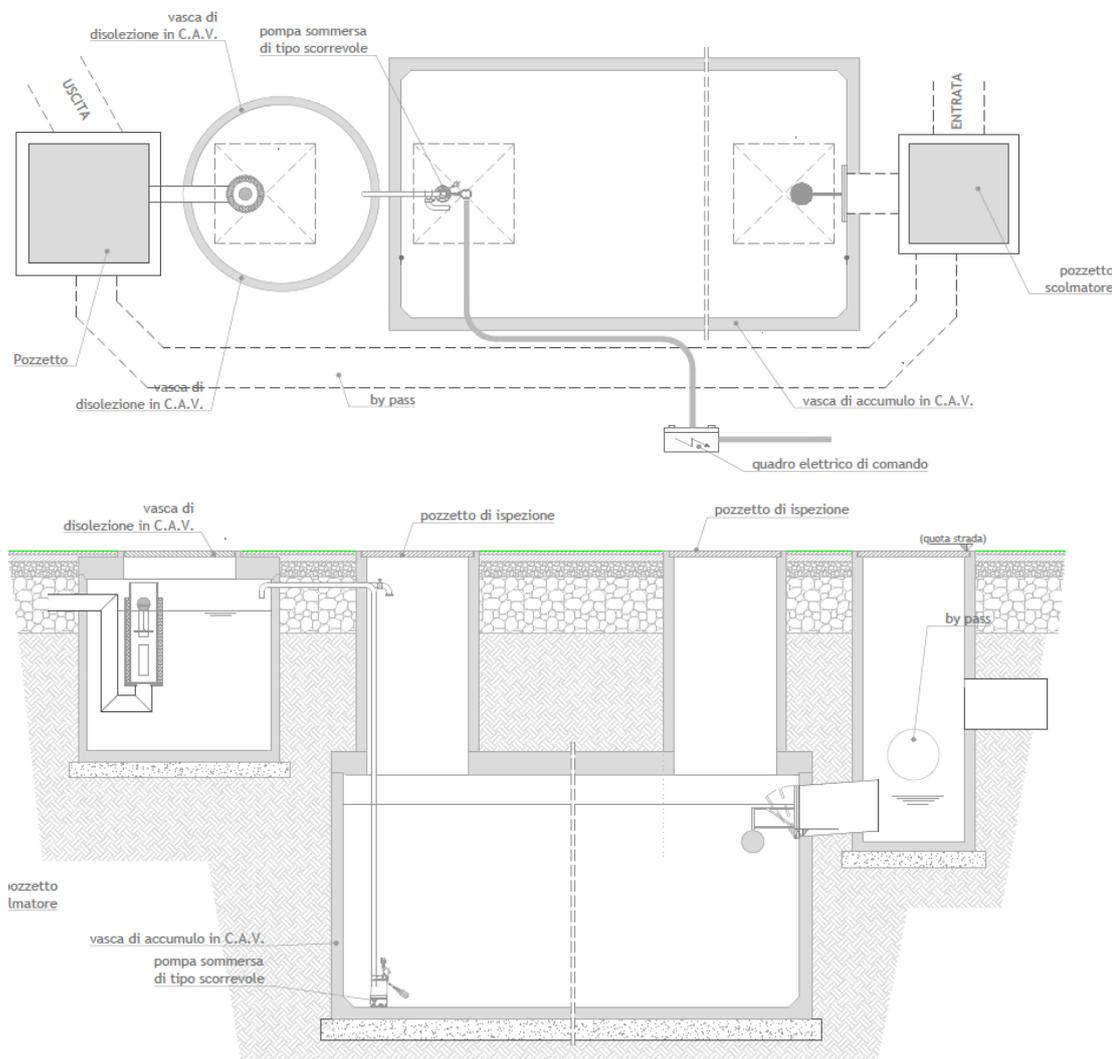
Figura 13 – Schema tipo sistema di trattamento acque di dilavamento
