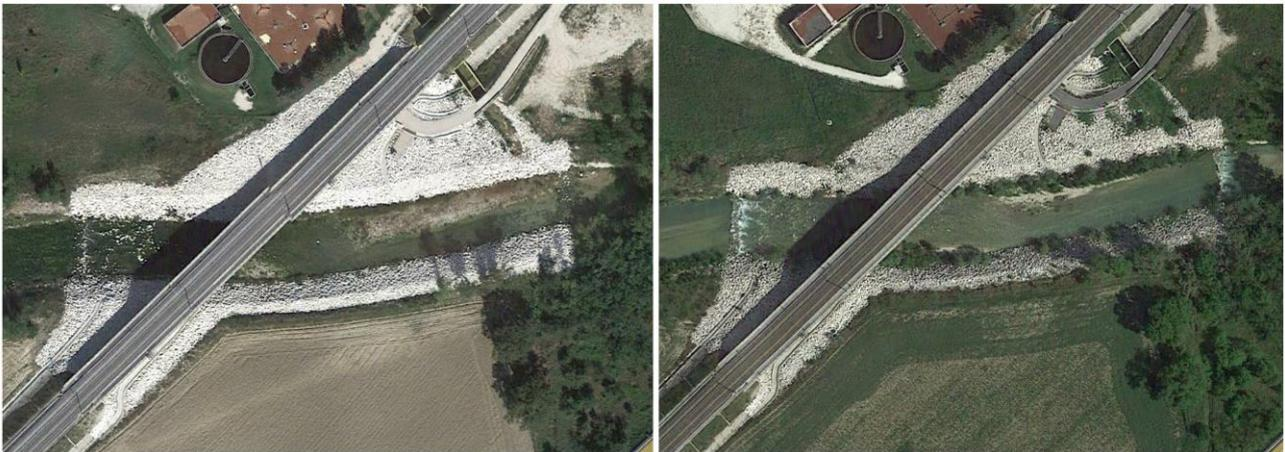
Figura 5 - Opere di sistemazione realizzate lungo il Fiume Esino, in corrispondenza del viadotto della linea ferroviaria Castelplanio – Montecarotto (a sinistra, appena realizzate 2017/2018; a destra 2022).
