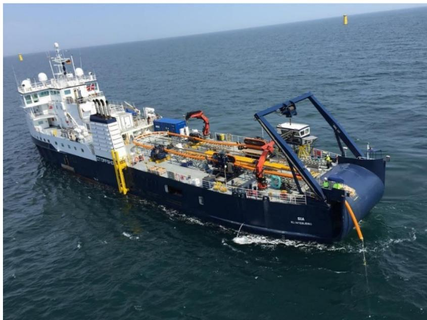
Figura 6-11 – Illustrazione dell'installazione del cavo (Fonte: Offshore Gode-wind)
