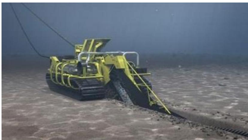
Figura 5-15 – Sistemi protezione dei cavi per interrimento
