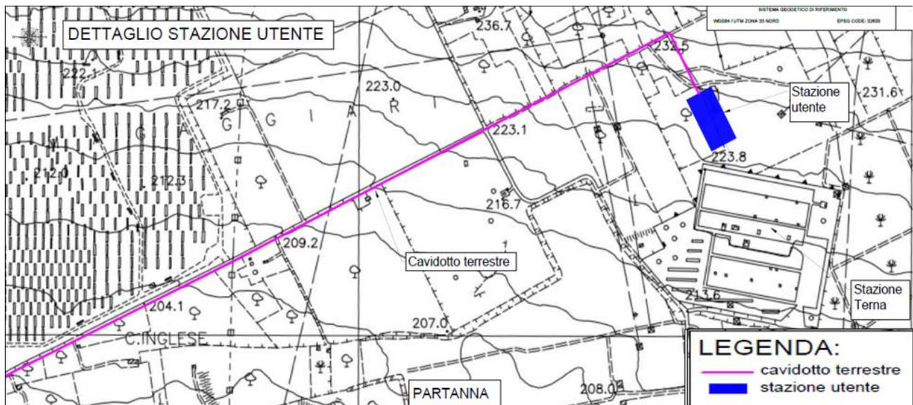
Figura 5.17 – Inquadramento su CTR dell'arrivo del cavidotto alla stazione Terna
