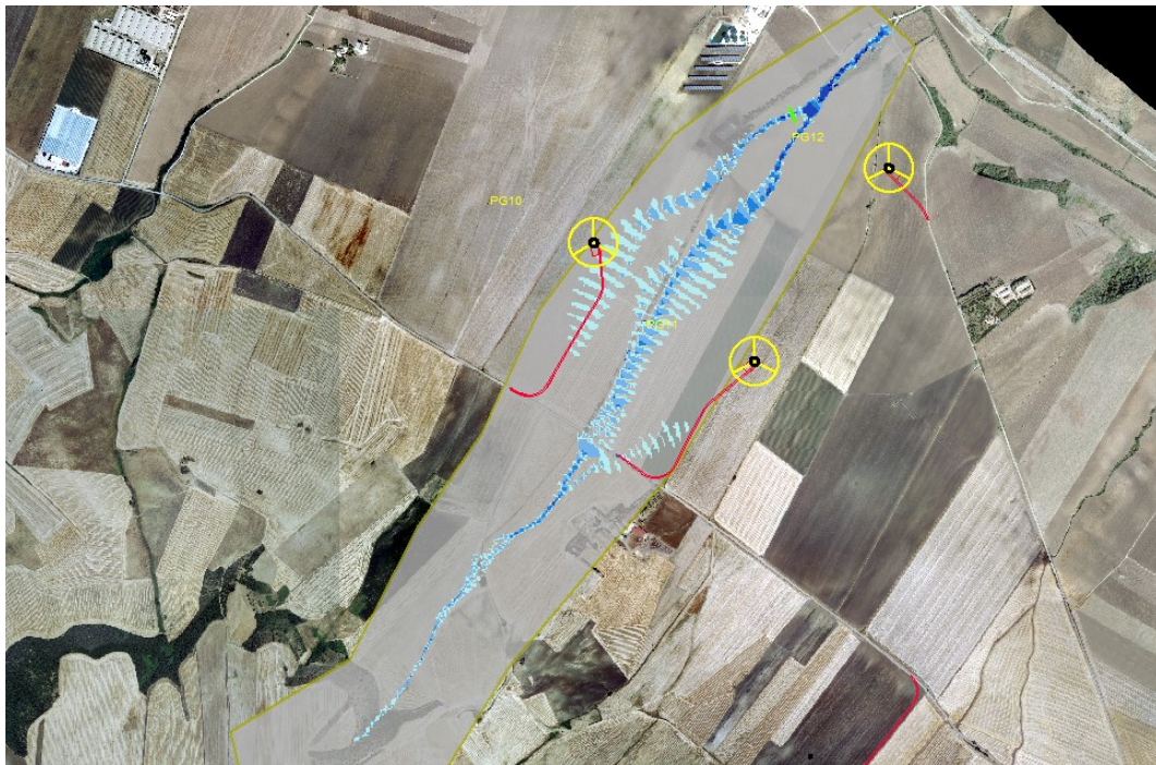
Figura 26: Dettaglio del terzo dominio di calcolo con indicazione della sezione di controllo indicata in verde e indicazione delle aree allagabili. La sezione di controllo è stata impiegata per il dimensionamento della canaletta di raccolta delle acque laterale alla strada di avvicinamento alla WTG PG10 e del tombino di attraversamento della stessa con una portata di 2,80 m 3 /s.
