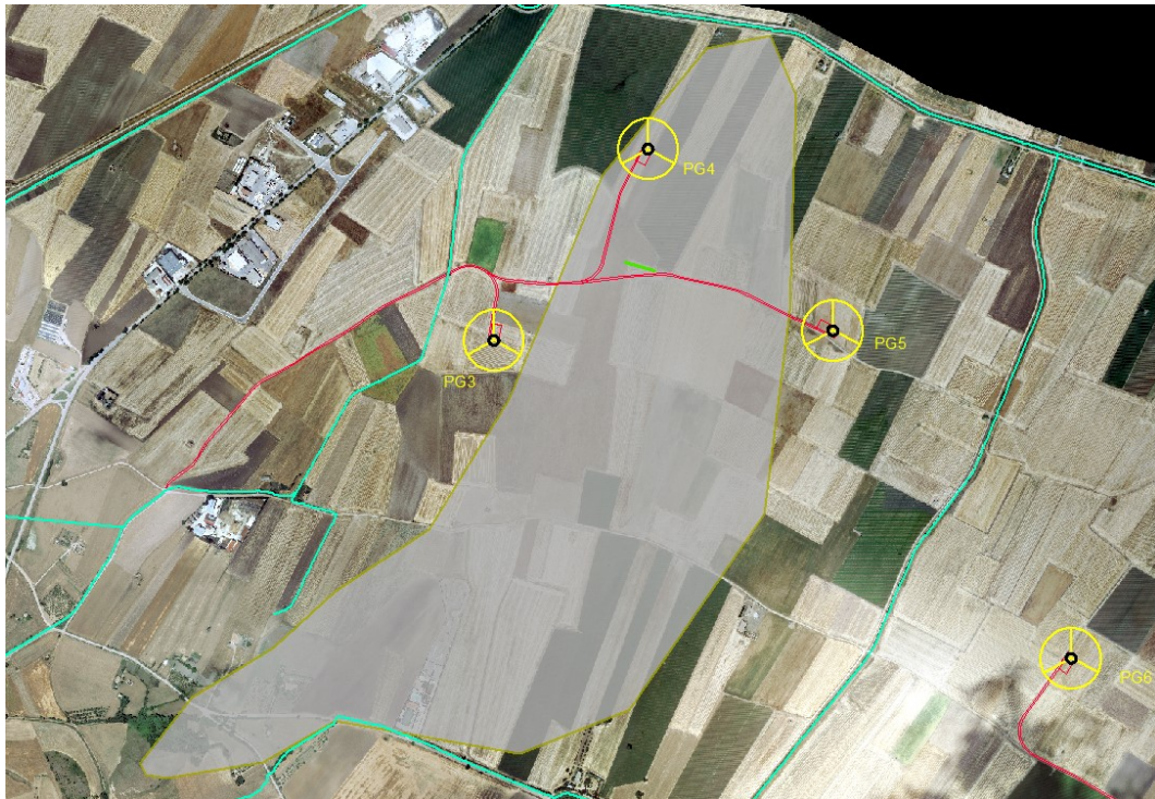
Figura 37: Dettaglio del nono dominio di calcolo con indicazione della sezione di controllo indicata in verde.
