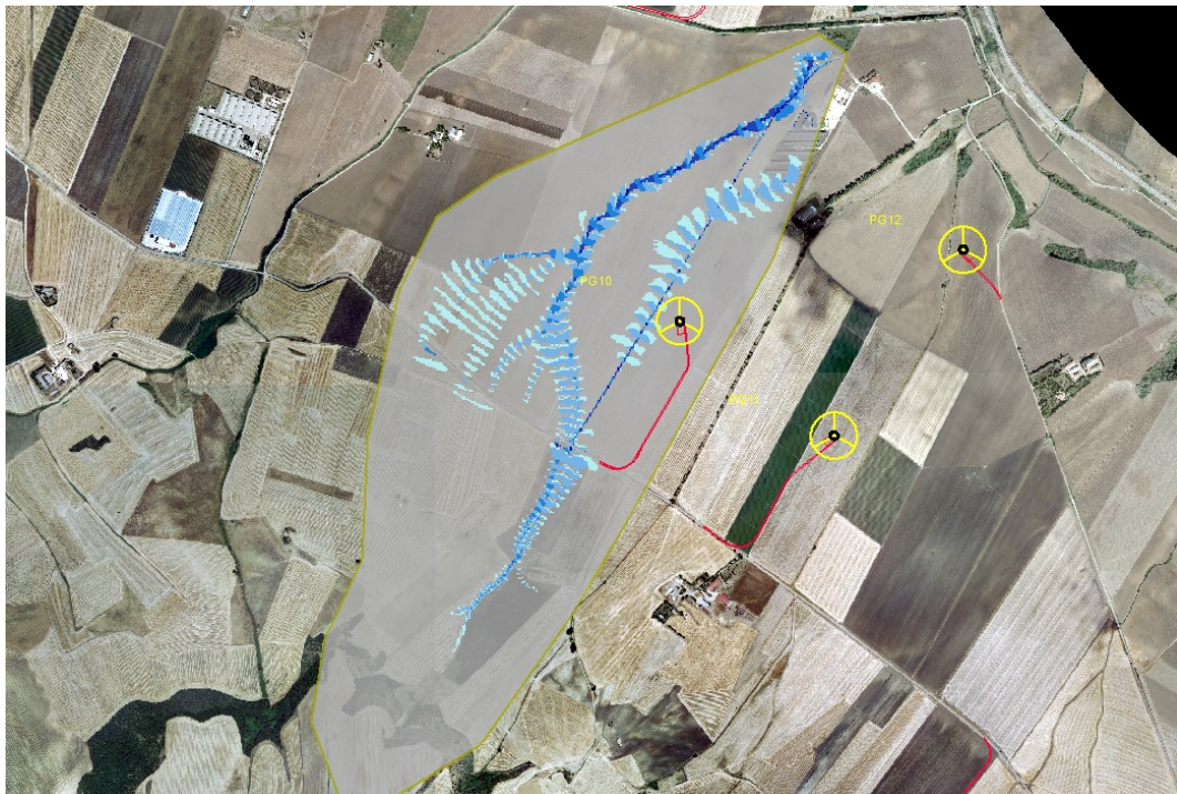
Figura 28: Dettaglio del quarto dominio di calcolo con indicazione delle aree allagabili a 200 anni. Non sono state inserite sezioni di controllo in quanto non risultano interferenze.
