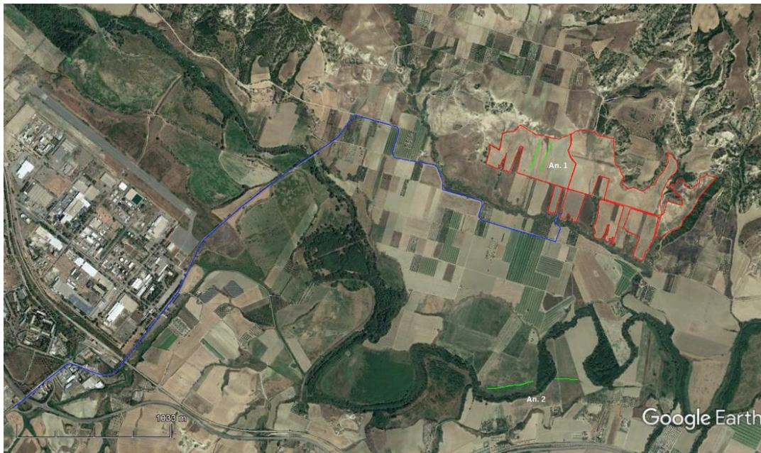
Fig. 2 Planimetria con le anomalie riscontrate (in rosso: area dell'impianto; in blu: tracciato del cavidotto; in verde . anomalie)
