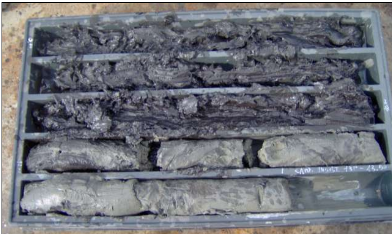
STRATIGRAFIA DA 0 - 13,5 M - SONDAGGIO SM3
