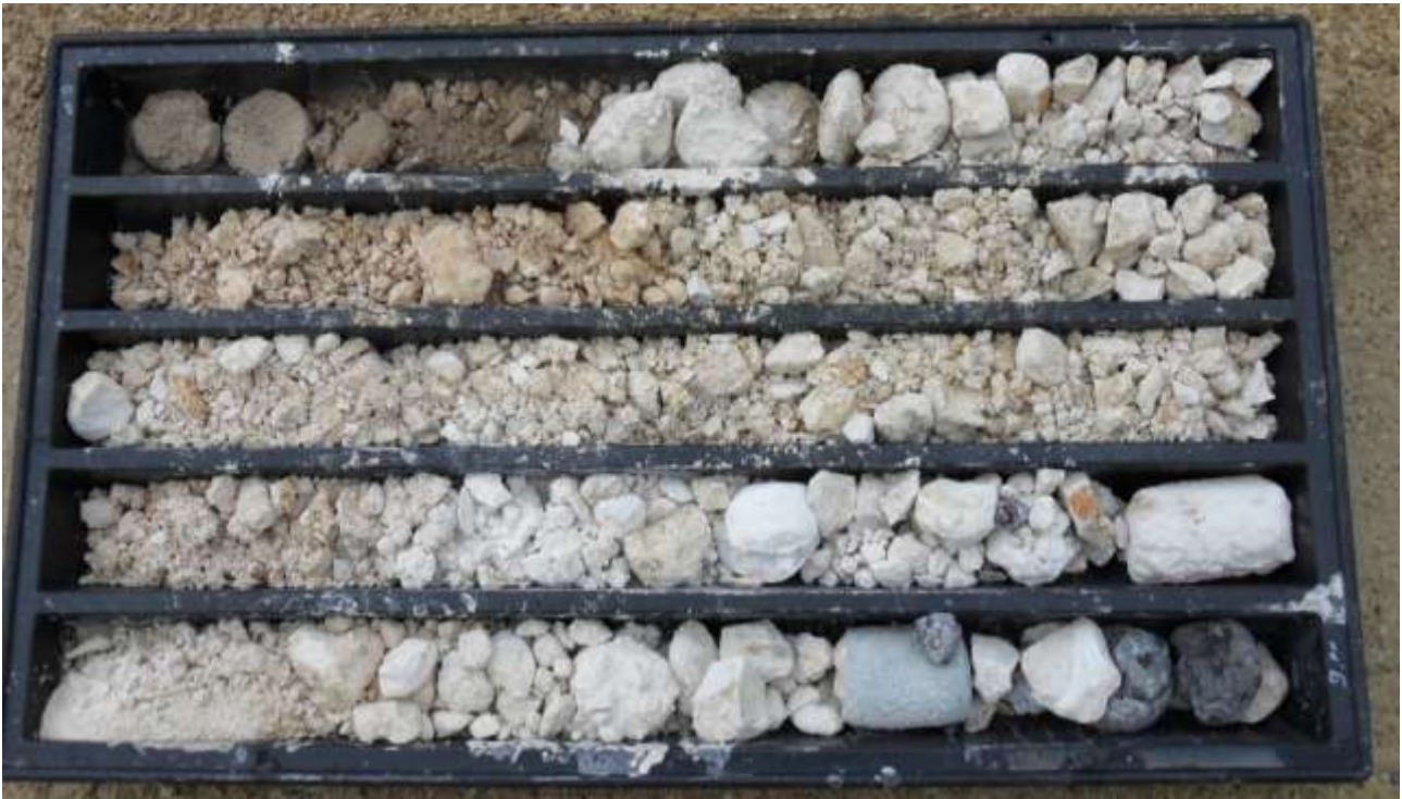
STRATIGRAFIA DA 0 -9,0 M - SONDAGGIO ST4
