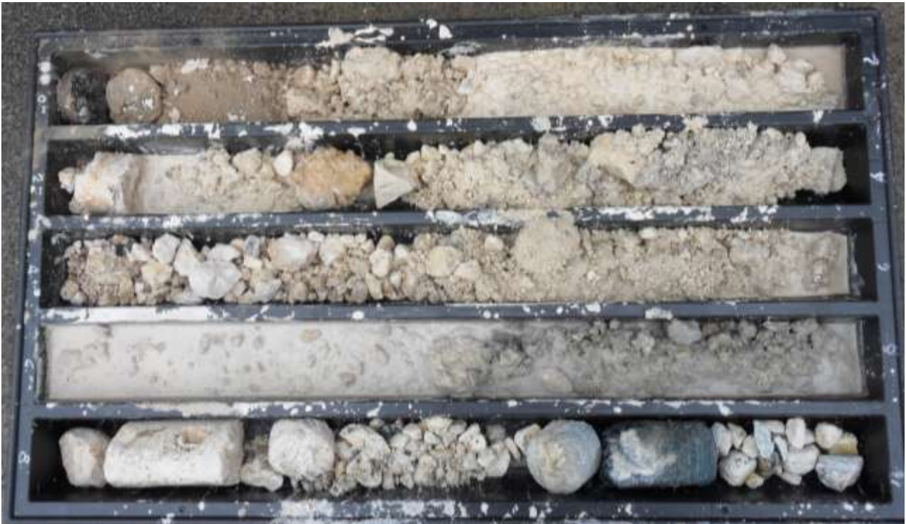
STRATIGRAFIA DA 0 -10 M - SONDAGGIO ST3
