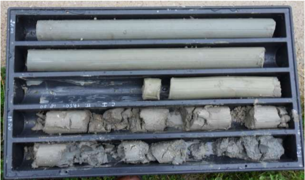
STRATIGRAFIA DA 15,0 -20,5 M – SONDAGGIO ST5
