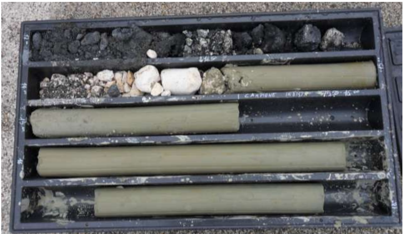
STRATIGRAFIA DA 12 - 18 M - SONDAGGIO ST 1
