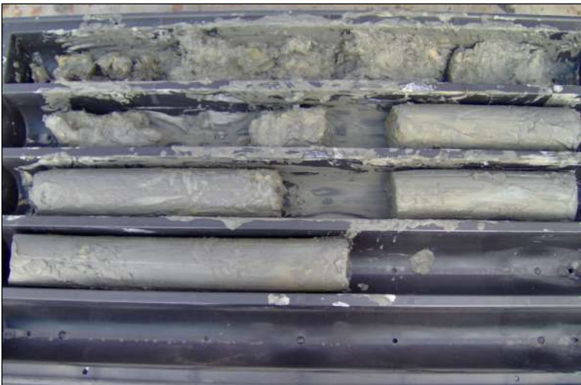
STRATIGRAFIA DA 0 -6,0 M - SONDAGGIO SM6
