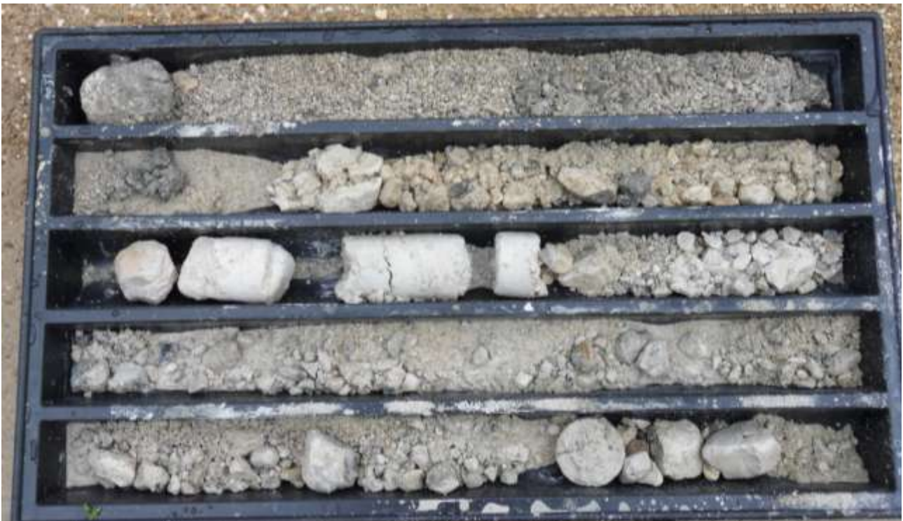
STRATIGRAFIA DA 7,5 -15,0 M - SONDAGGIO ST5
