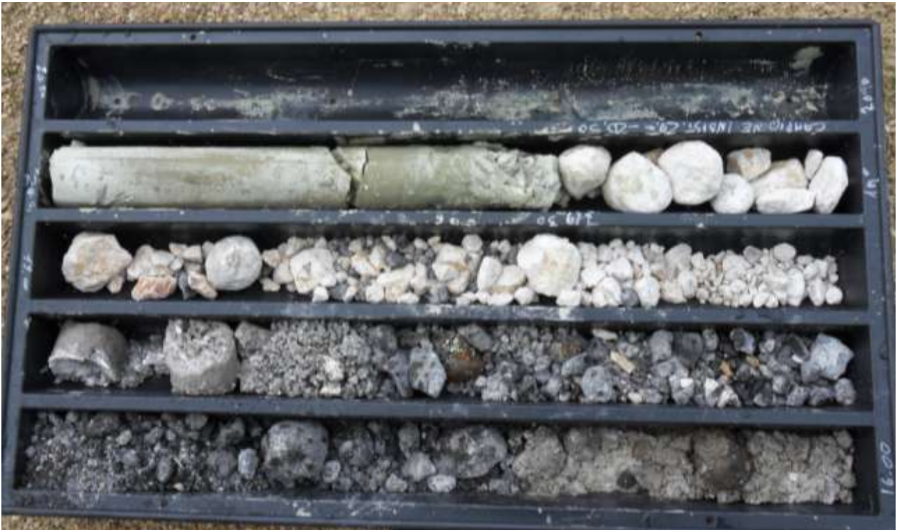
STRATIGRAFIA DA 16,0 -20,5 M – SONDAGGIO ST4
