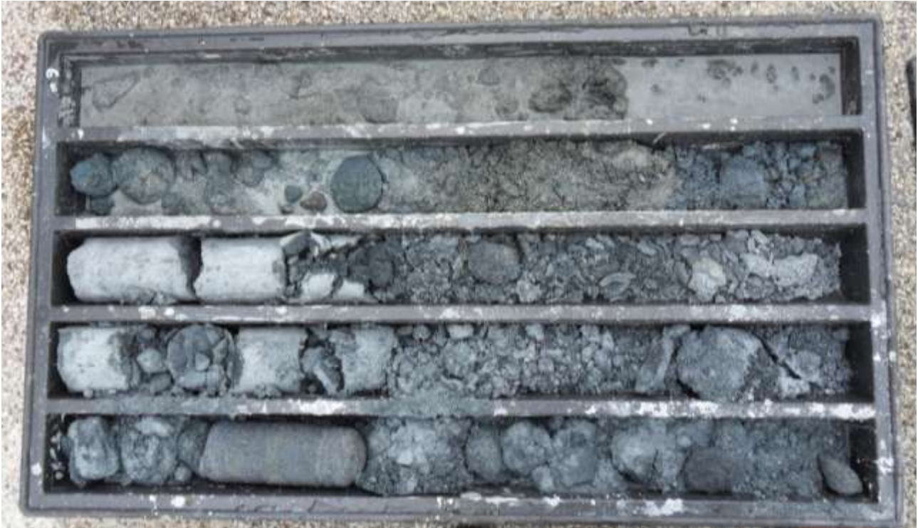
STRATIGRAFIA DA 6 -12 M - SONDAGGIO ST1
