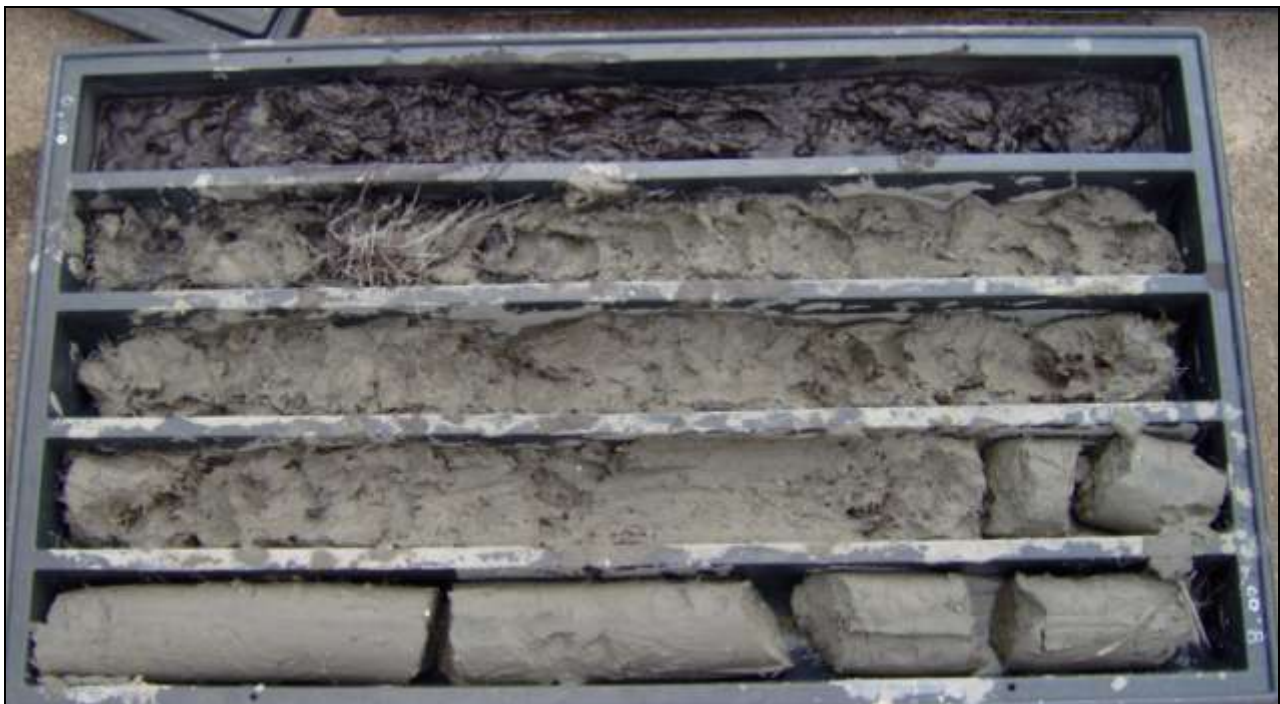
STRATIGRAFIA DA 0 -8,0 M - SONDAGGIO SM15
