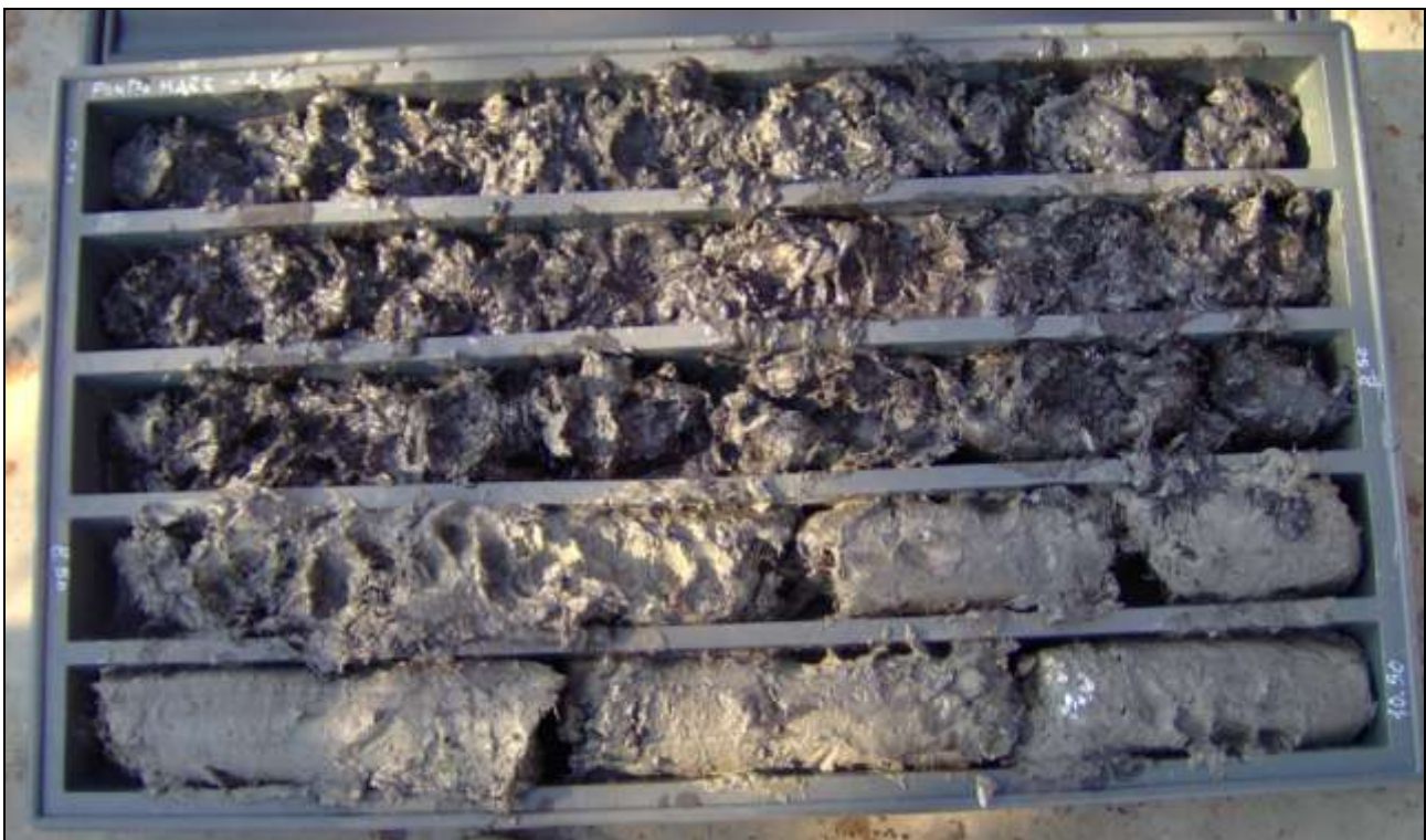
STRATIGRAFIA DA 0 - 11,0 M - SONDAGGIO SM2
