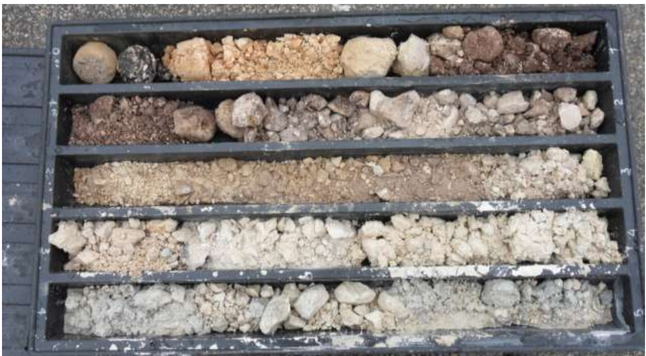
STRATIGRAFIA DA 0 -5,0 M - SONDAGGIO ST2
