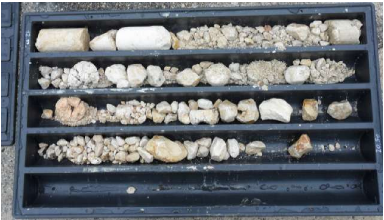
STRATIGRAFIA DA 12 -20,5 M - SONDAGGIO ST2
