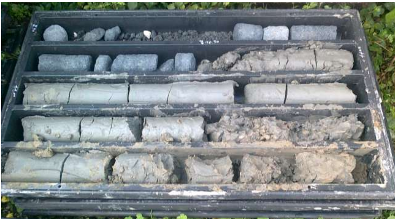
STRATIGRAFIA DA 8,5 -16,0 M - SONDAGGIO ST6
