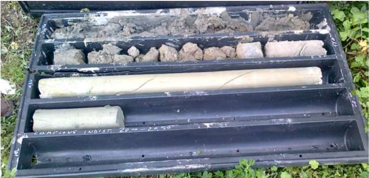
STRATIGRAFIA DA 16,0 -20,5 M - SONDAGGIO ST6
