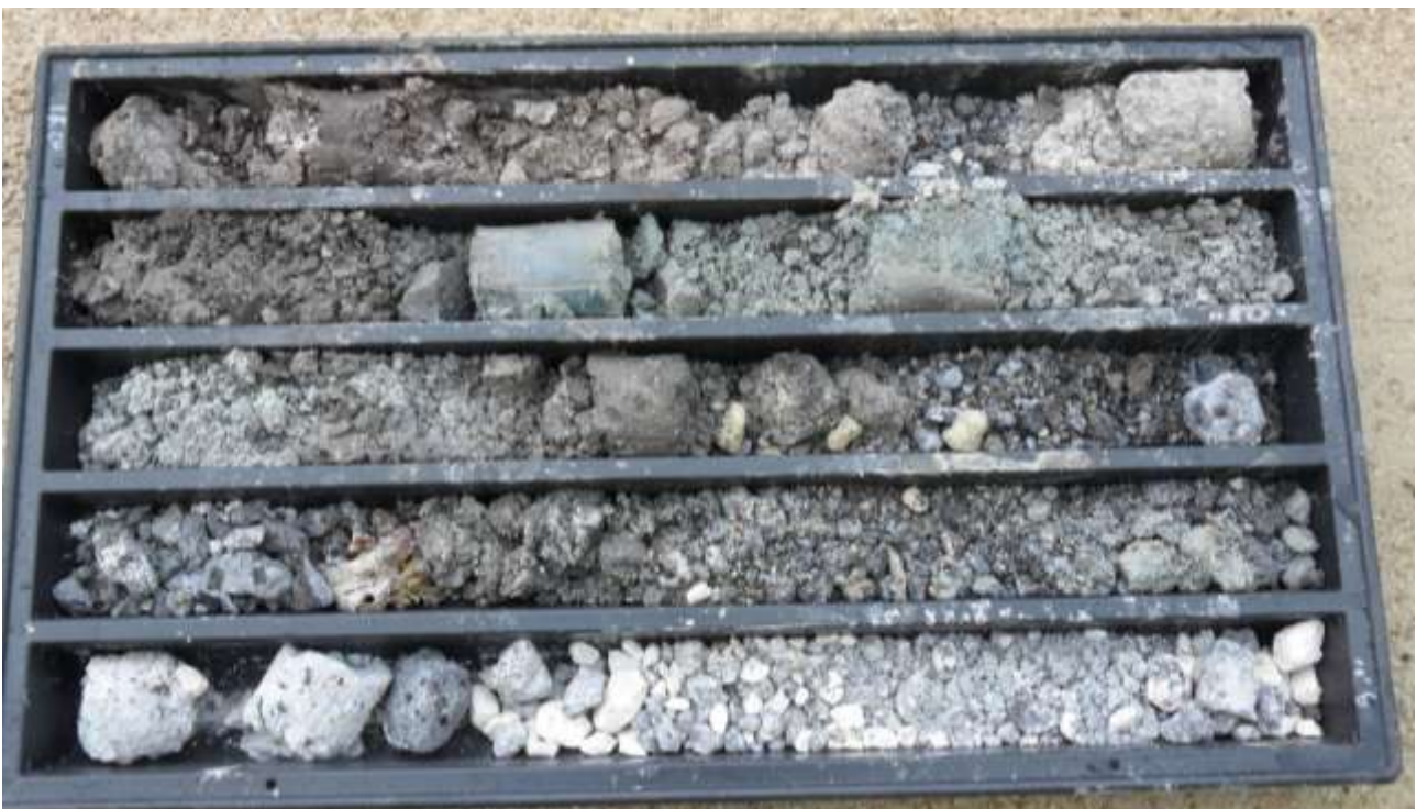
STRATIGRAFIA DA 9,0 -16,0 M - SONDAGGIO ST4
