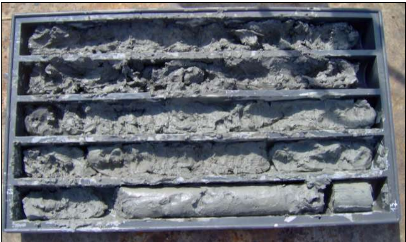
STRATIGRAFIA DA 0 - 13 M - SONDAGGIO SM1
