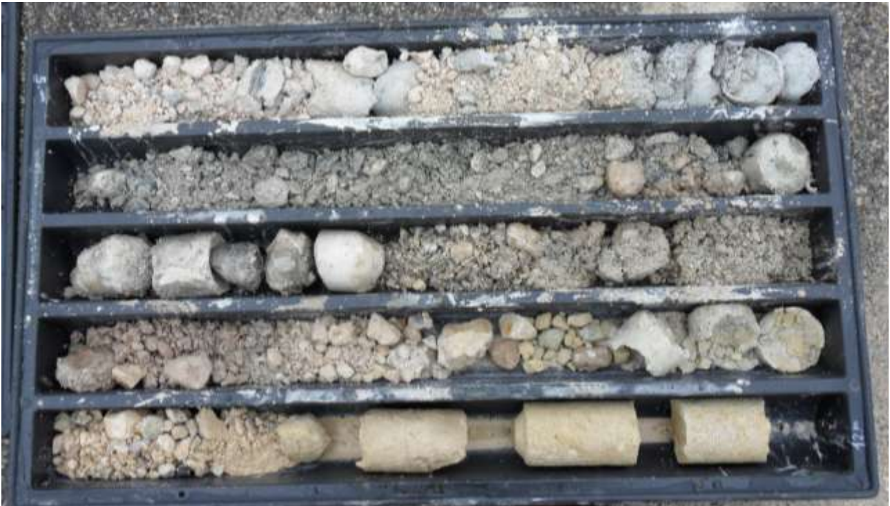
STRATIGRAFIA DA 5,0 -12,0 M - SONDAGGIO ST2
