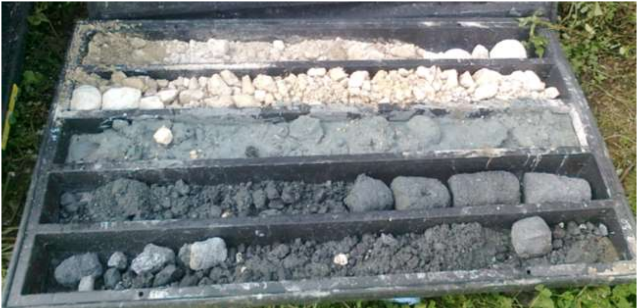
STRATIGRAFIA DA 0 -8,5 M - SONDAGGIO ST6
