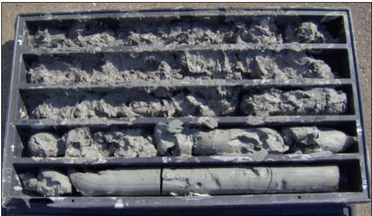
STRATIGRAFIA DA 0 - 14,0 M - SONDAGGIO SM8
