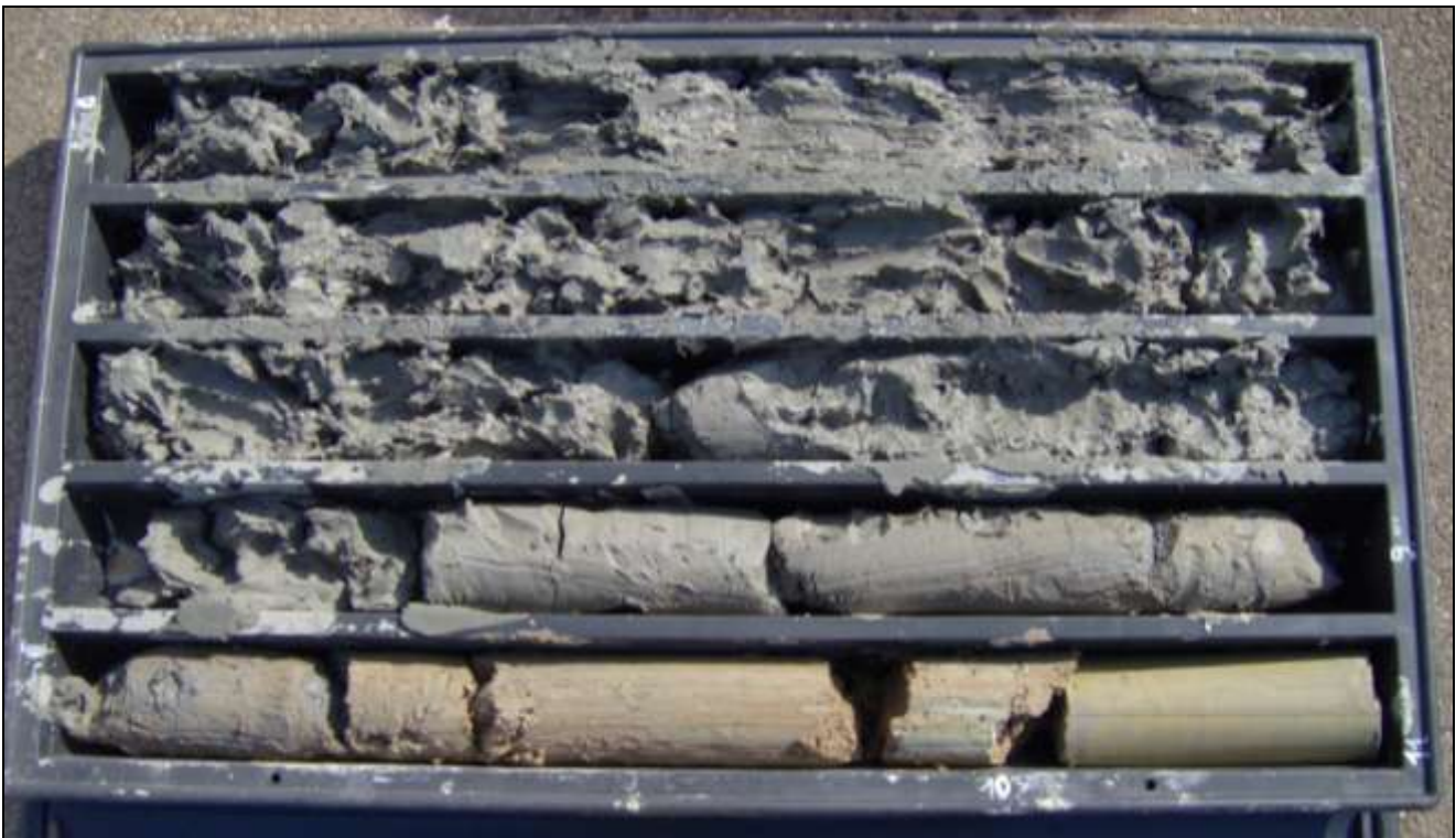
STRATIGRAFIA DA 0 - 11,0 M - SONDAGGIO SM10
