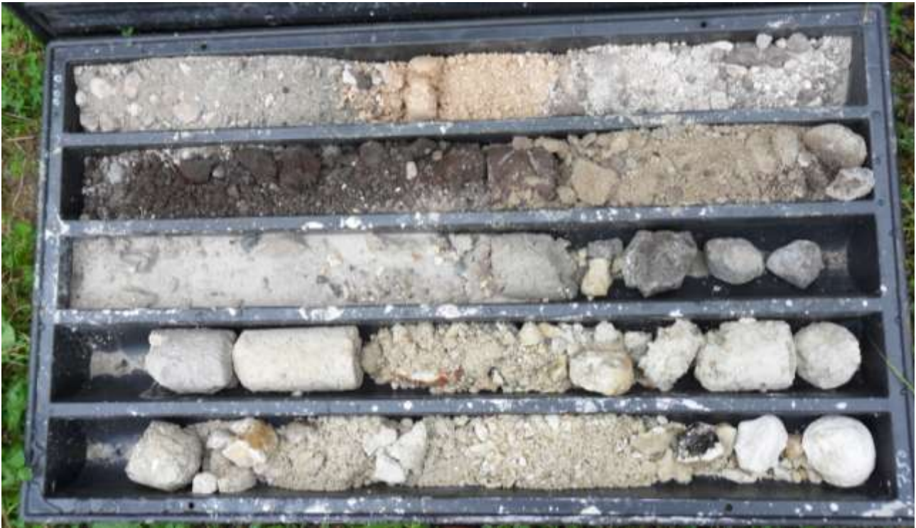
STRATIGRAFIA DA 0 -7,5 M - SONDAGGIO ST5
