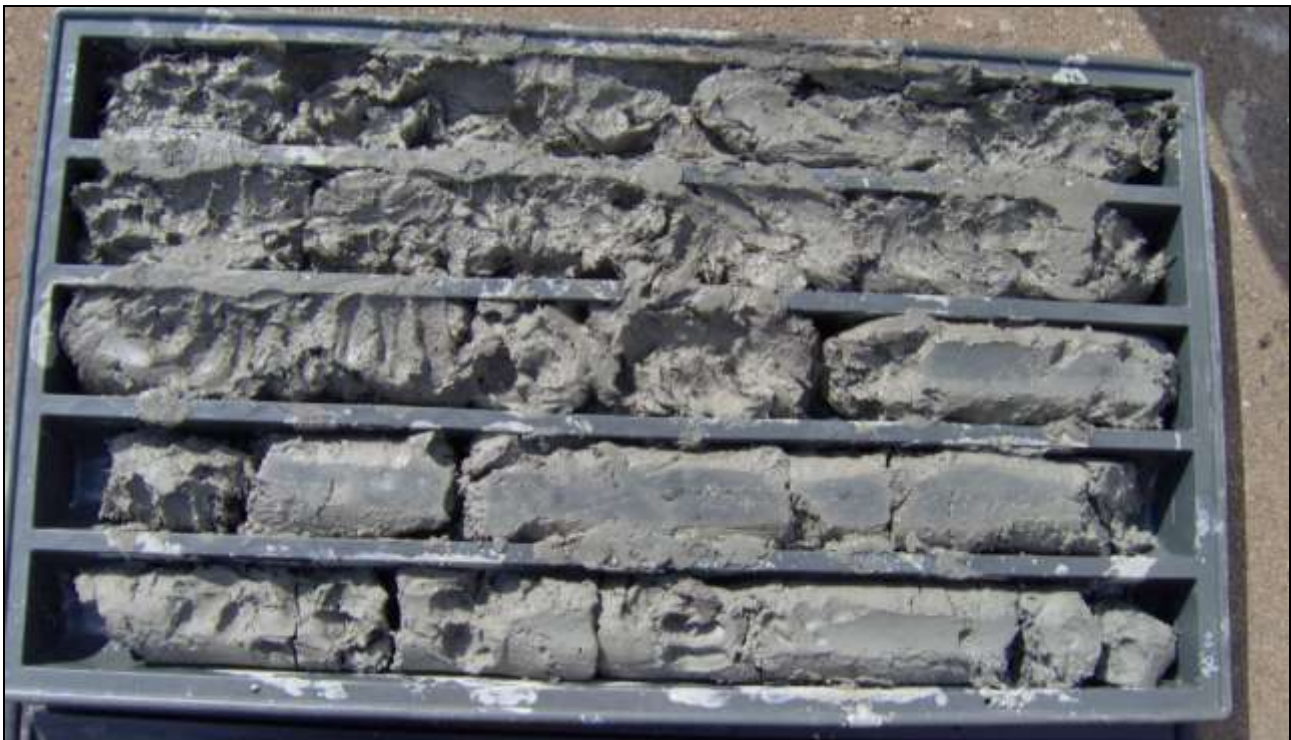
STRATIGRAFIA DA 0 - 10,0 M - SONDAGGIO SM7
