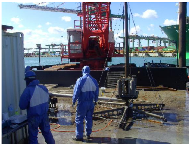
Foto 2 – Vibro carotiere Geo-core 3000 con carotiere da 3 metri.
