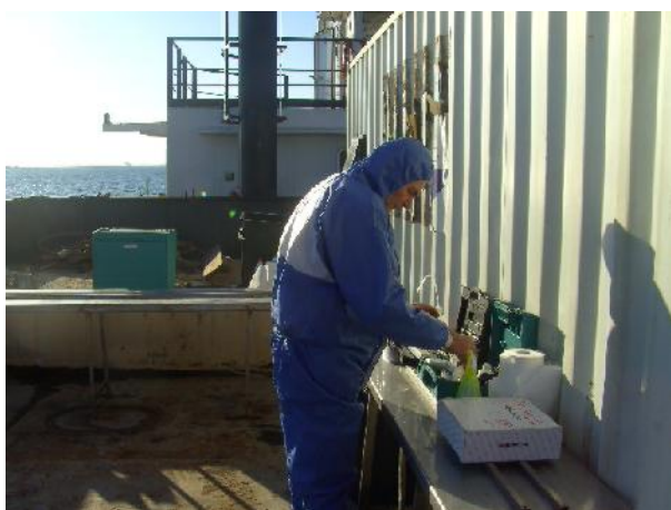
Figura 4 - Misure di pH e raccolta aliquota per composti volatili.
