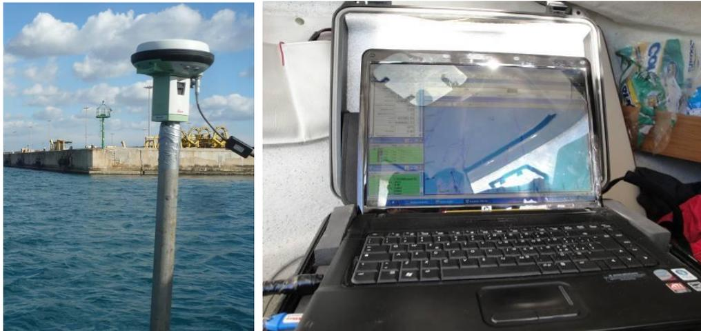
*Rilievo DGPS e software di navigazione*
