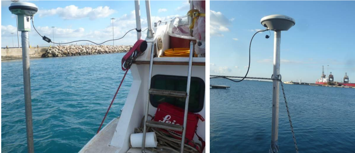
Sistema di posizionamento GPS RTK;
