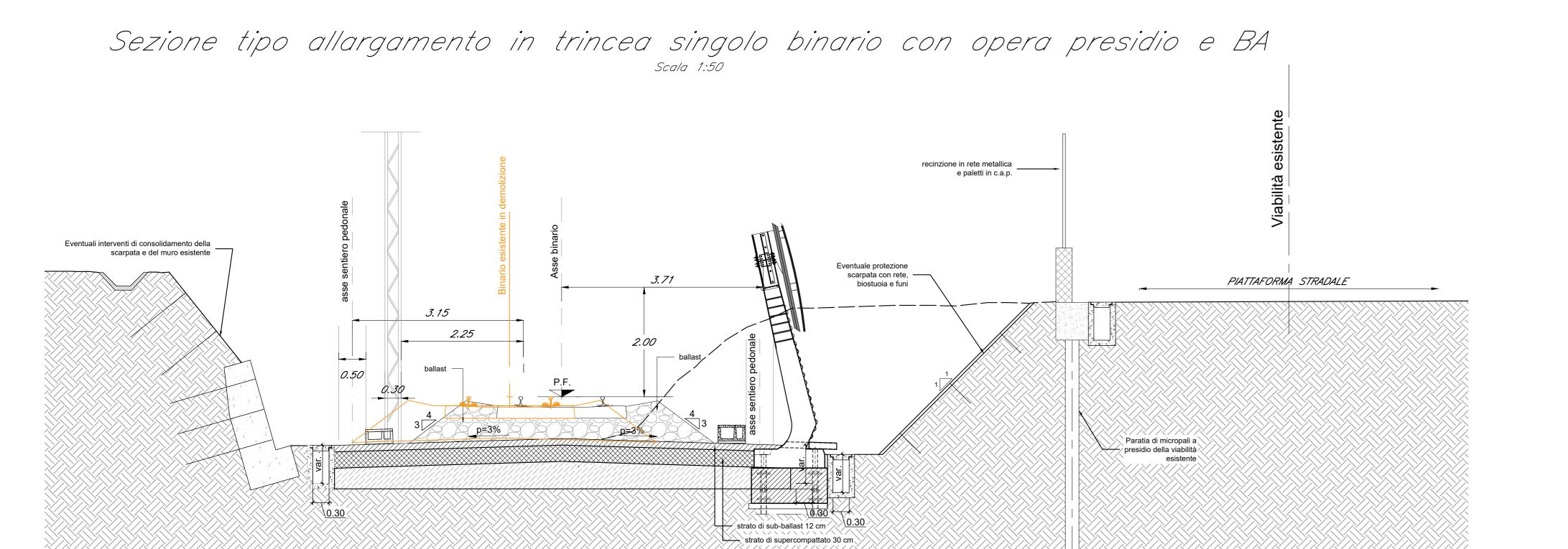
Sezione tipo allargamento in trincea singolo binario
