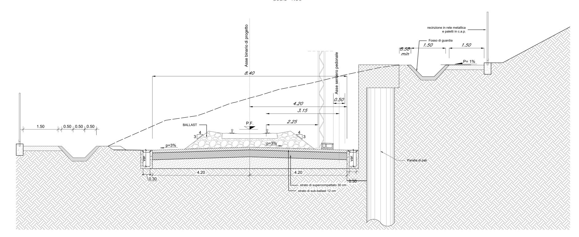
Sezione tipo in trincea singolo binario scala
