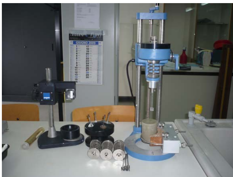
Fig. 12: Scissometro da laboratorio e penetrometro a cono GEONOR.
