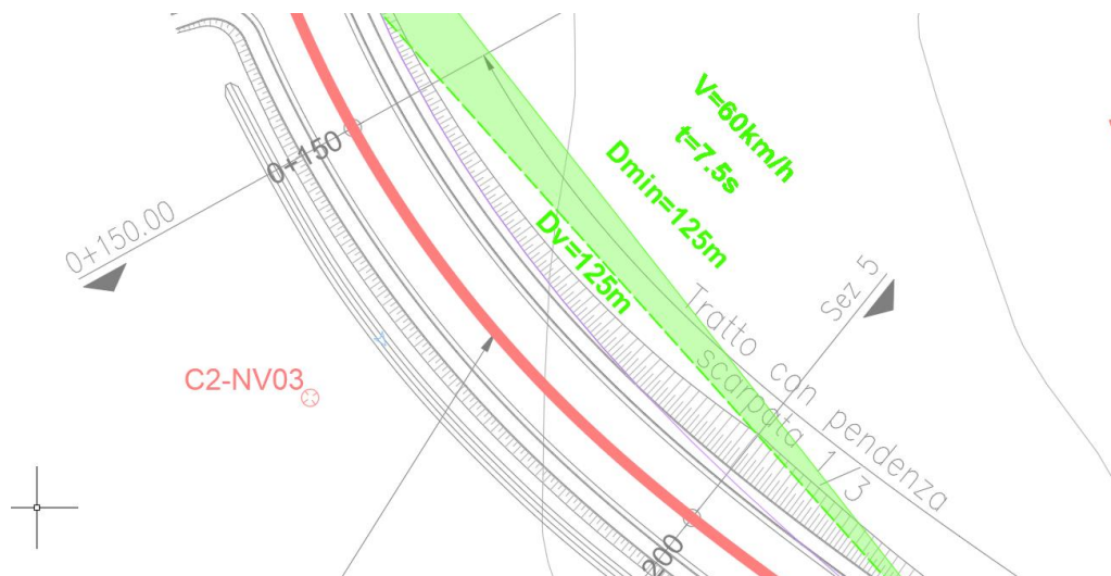
Figura 8.2.2 Visibilità intersezione con Contrada Falà-NV01 (veicolo in movimento a destra)
