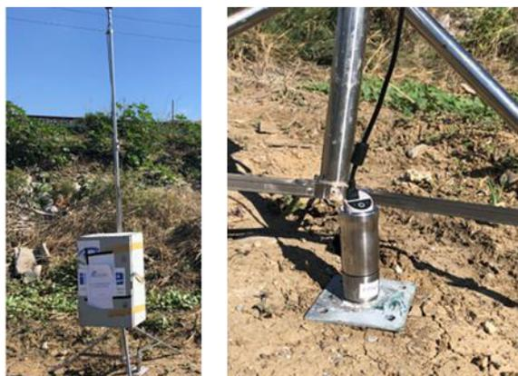
Figura 4-2 Esempio di installazione dell'accelerometro
