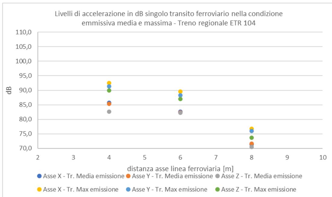
Figura 4-4 Postazione VIB\_01, linea ferroviaria in rilevato: livelli di accelerazione rappresentativi delle condizioni di massima e media emissione di un singolo transito ferroviario a 4, 6 e 8 m dal binario più esterno - Treno Regionale ETR 104
