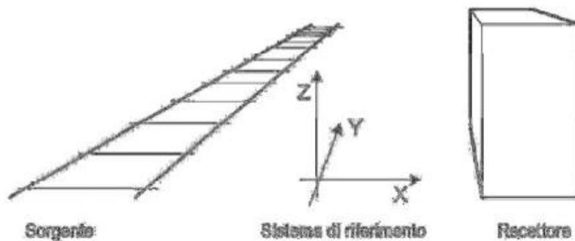
Figura 4-1 Orientamento delle componenti vibrazionali rispetto alle sorgenti
