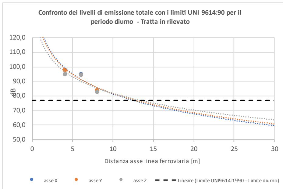
Figura 6-1 Confronto dei livelli di emissione complessiva all'interno degli edifici con i limiti UNI 9614:1990 in funzione della distanza dall'asse della linea secondo il modello di esercizio previsto – Tratta 1, sezione rilevato - Periodo diurno
