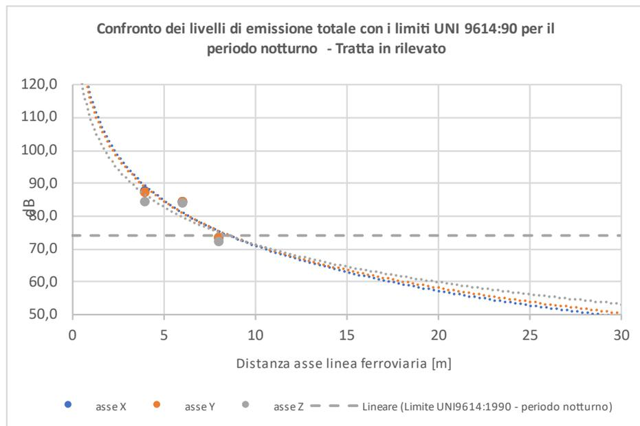
Figura 6-2 Confronto dei livelli di emissione complessiva all'interno degli edifici con i limiti UNI 9614:1990 in funzione della distanza dall'asse della linea secondo il modello di esercizio previsto – Tratta 1, sezione rilevato - Periodo notturno
