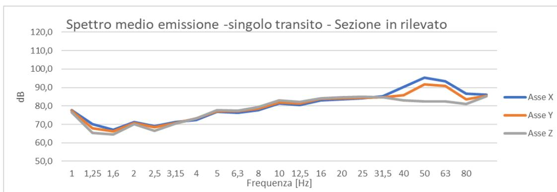
Figura 4-3 Spettro medio dei transiti rilevati presso la postazione T1 in prossimità del binario
