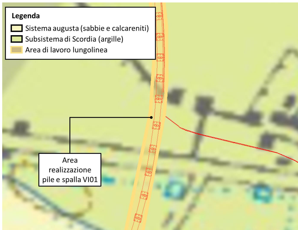
Figura 6-28 Scenario A: Realizzazione pile e spalle viadotto VI01 - inquadramento geologico delle aree di cantiere
