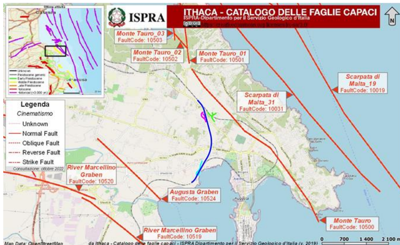
Figura 5-14 – Stralcio cartografico dell'area di interesse, riprodotto in scala 1:70000, con indicazione schematica del tracciato in questione (in blu), e delle faglie capaci (in rosso).
