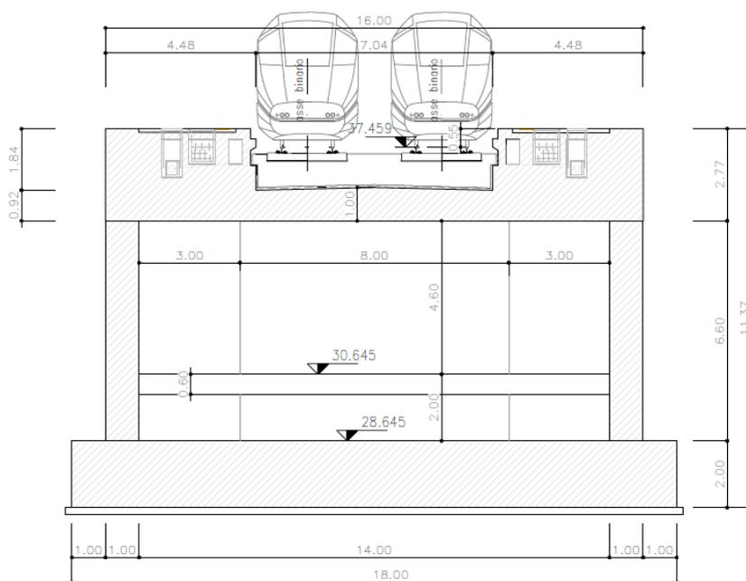
Figura 2-6 Scatolare di stazione – FV01: Sezione tipo
