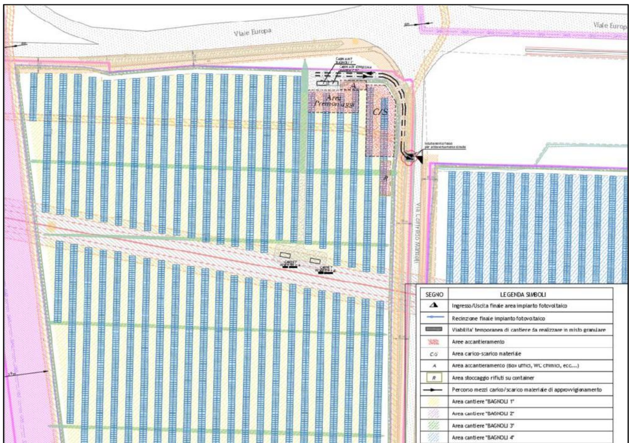
Figura 3-11 - Aree di cantiere impianto BAGNOLI 1
