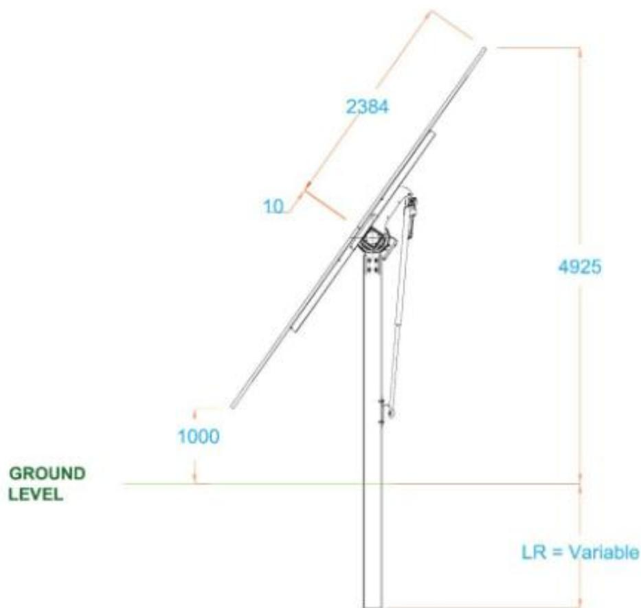
Figura 2 – Struttura tracker: modalità di installazione e principali quote
