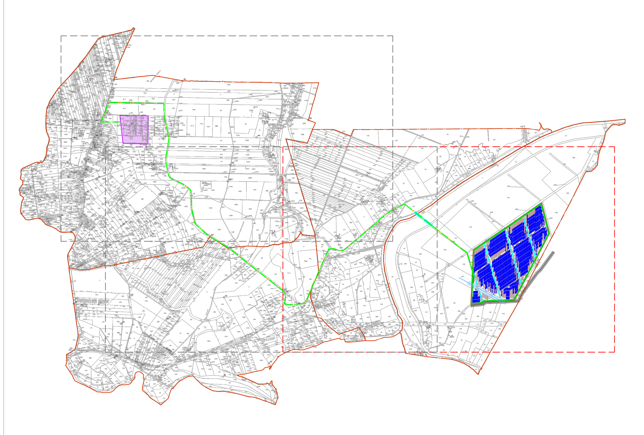
PLANIMETRIA IMPIANTO FOTOVOLTAICO SU STRALCIO CATASTALE - FOGLI DI MAPPA NN. 4, 5, 6, 7 DEL COMUNE DI CARLENTINI (SR) | SCALA 1:4.000
