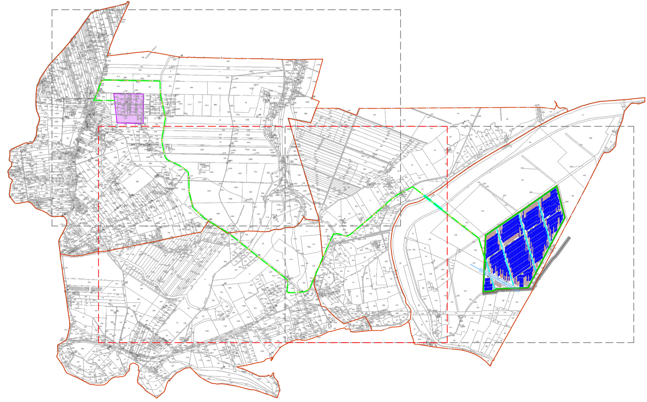
PLANIMETRIA IMPIANTO FOTOVOLTAICO SU STRALCIO CATASTALE - FOGLI DI MAPPA NN. 4, 5, 6, 7 DEL COMUNE DI CARLENTINI (SR) | SCALA 1:4.000
