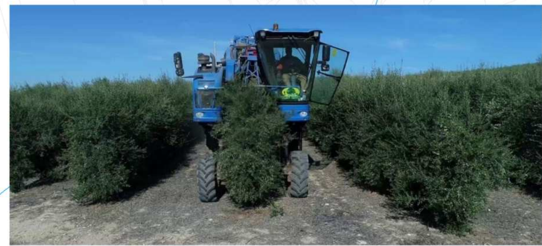
Macchina scavallatrice durante le operazioni di raccolta in oliveto superintensivo a siepone
