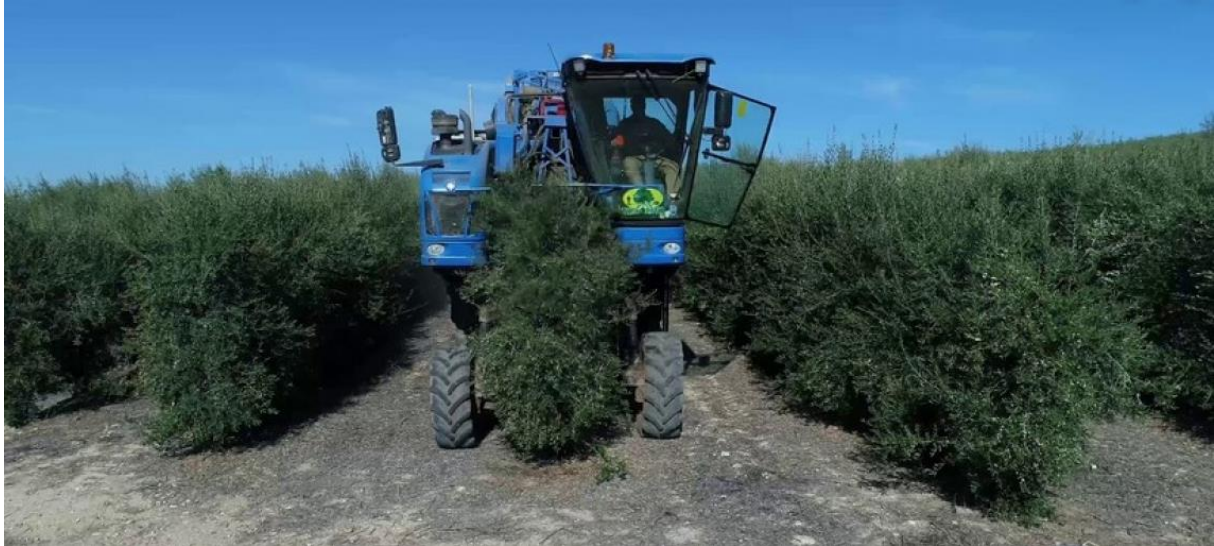
Foto 3 - Macchina scavallatrice durante le operazioni di raccolta in oliveto superintensivo a siepone
