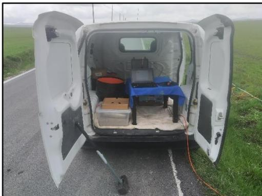
**Fotografia 7**-Sismografo PASI modello GEA24
