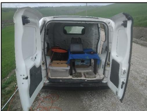
**Fotografia 19**-Sismografo PASI modello GEA24
