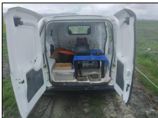
**Fotografia 15**-Sismografo PASI modello GEA24
