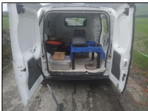
**Fotografia 3**-Sismografo PASI modello GEA24
