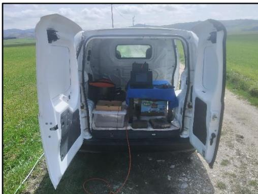
**Fotografia 31**-Sismografo PASI modello GEA24
