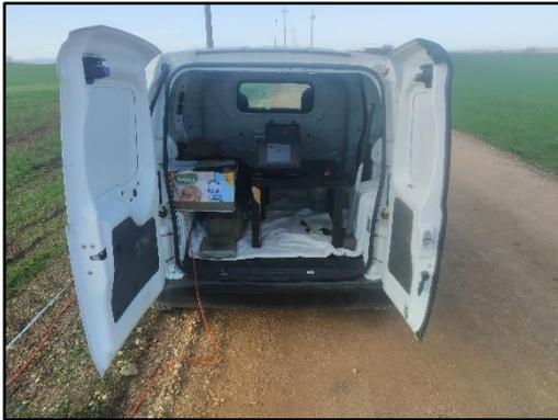
Fotografia 39-Sismografo PASI modello GEA24
