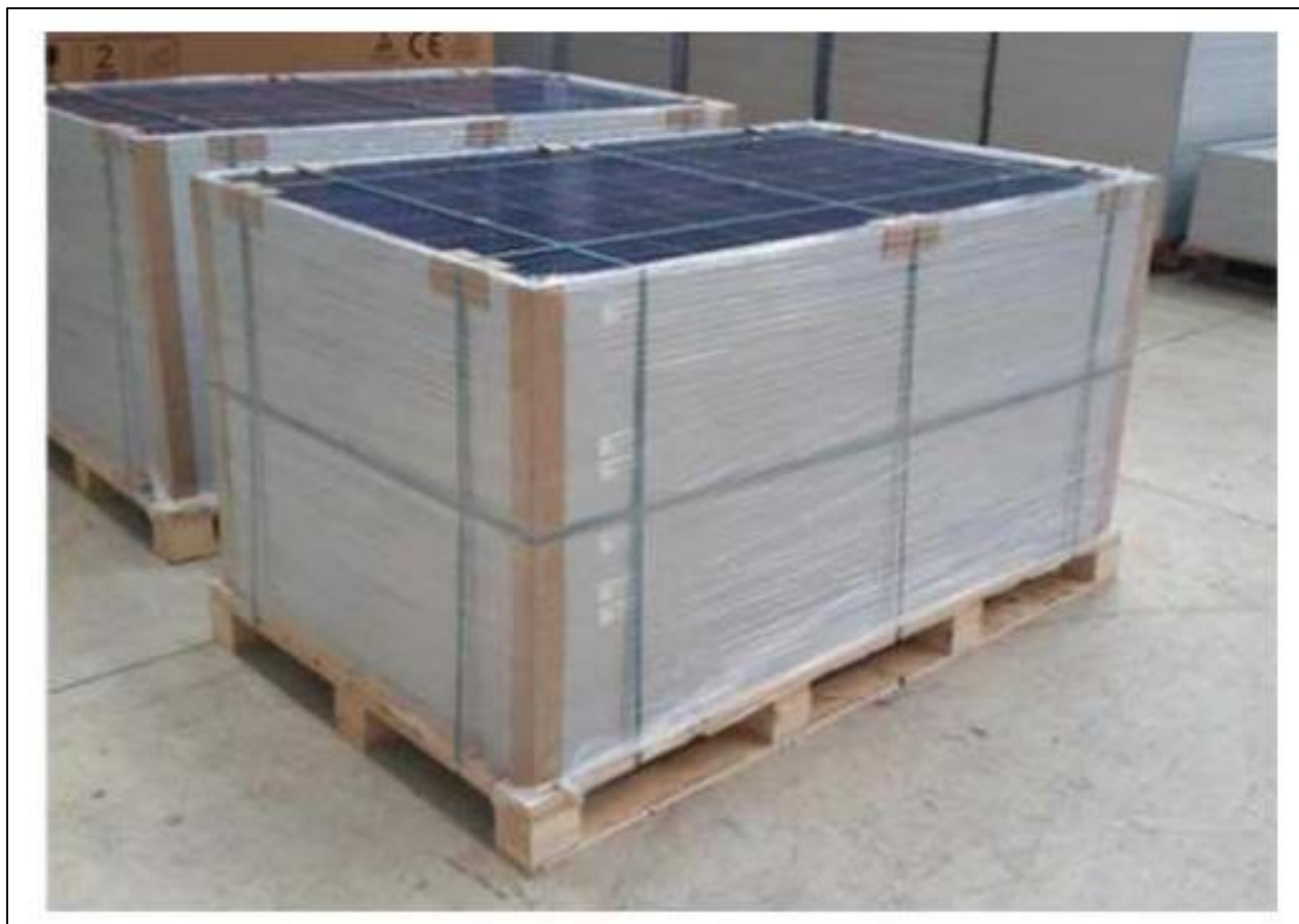
Figura 6: Impilamento e reggiatura dei pannelli fotovoltaici
