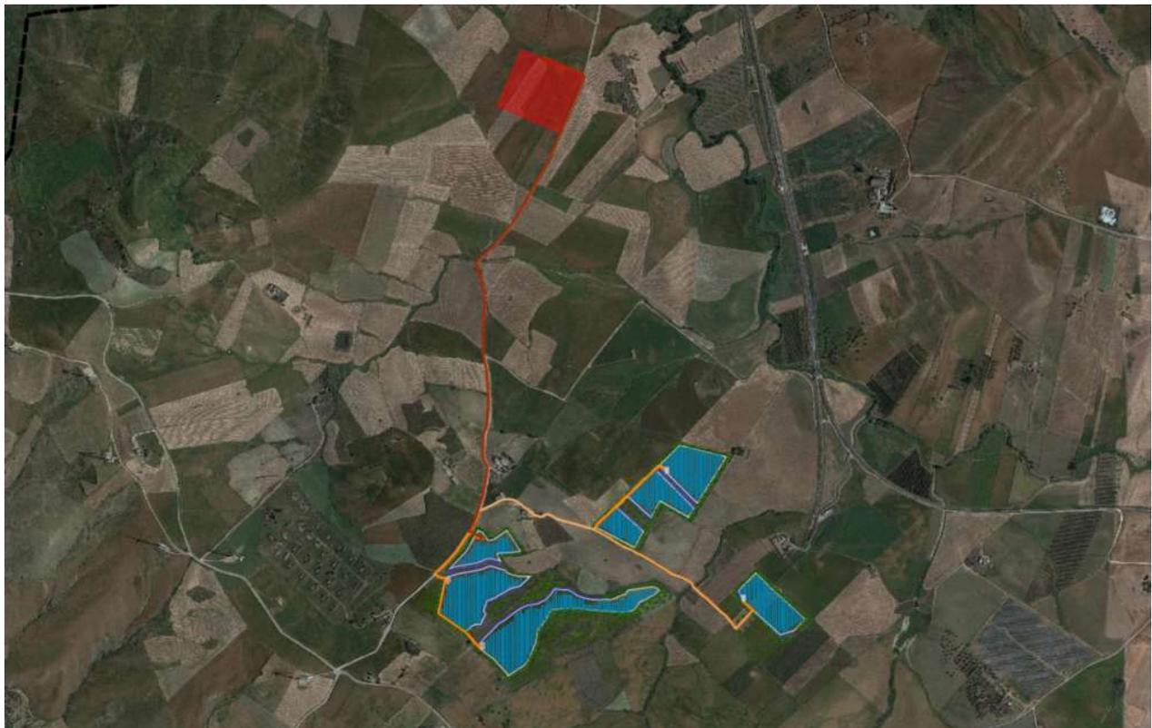
*Figura 32 - Layout impianto e collegamento con SSE su ortofoto*
