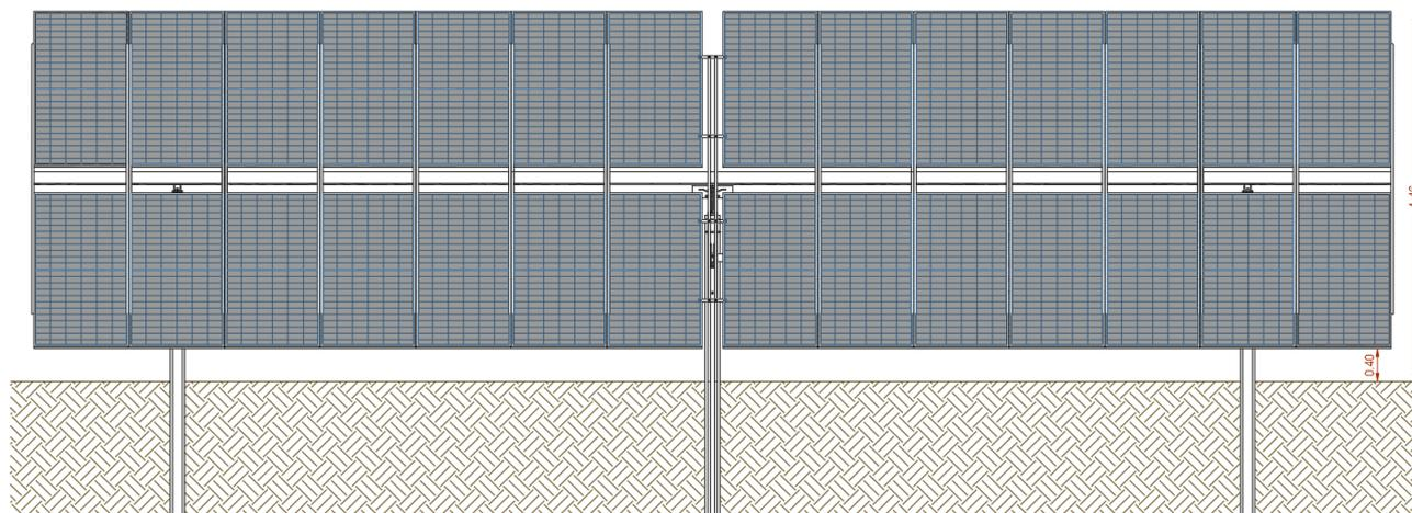
*Figura 9 - Tracker 2P con moduli FV - vista longitudinale*
