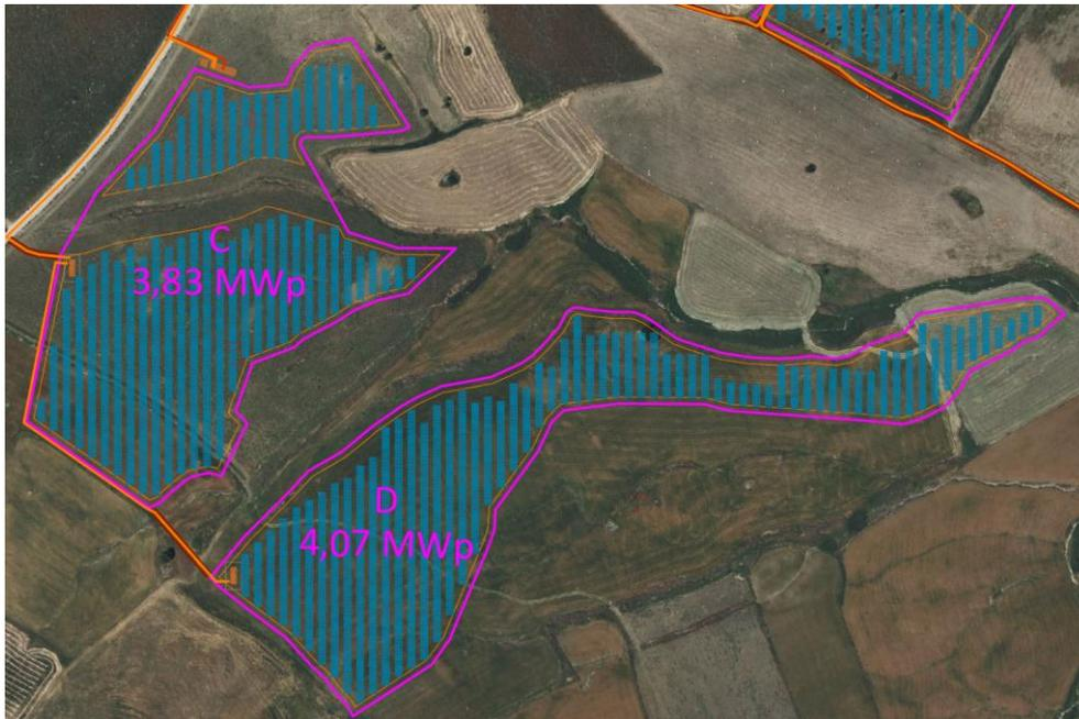
*Figura 16 - Collegamento entra-esce PS Sottocampo D e Sottocampo C*
