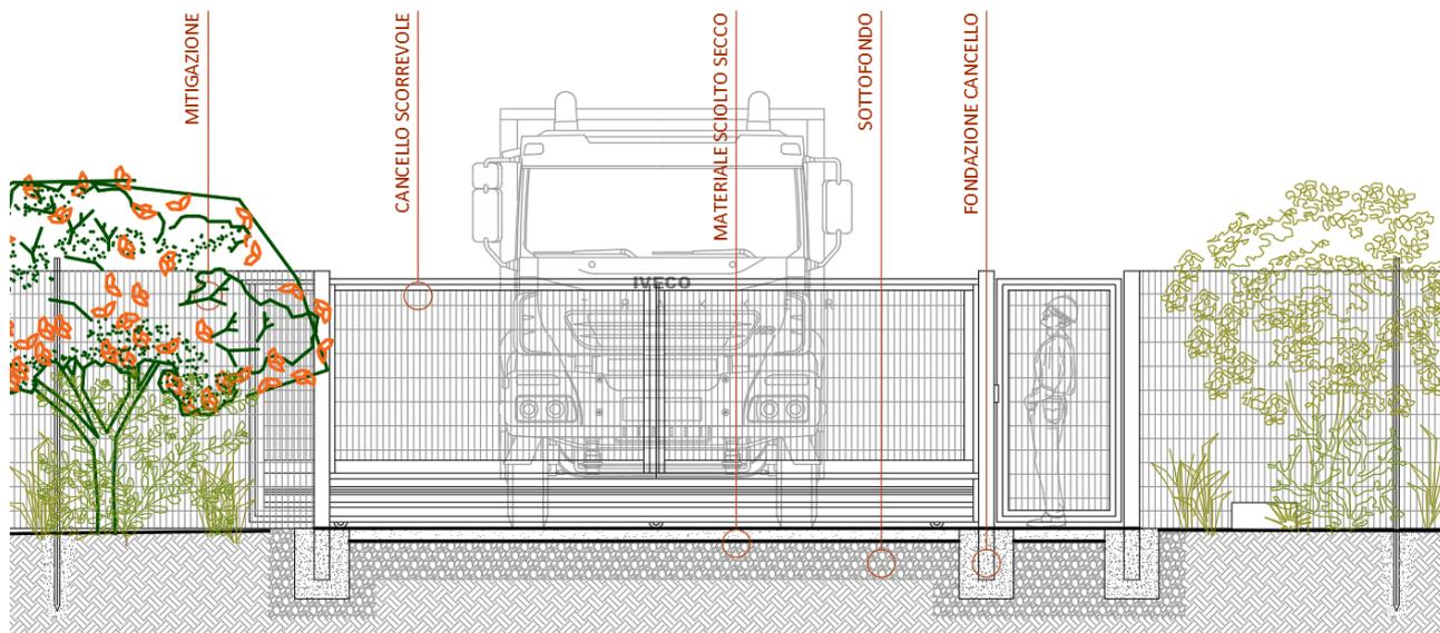
**Figura 17 - Particolari delle recinzioni, cancelli e piantumazione perimetrale (Rif. FV.CST01.PD.F.02)**
