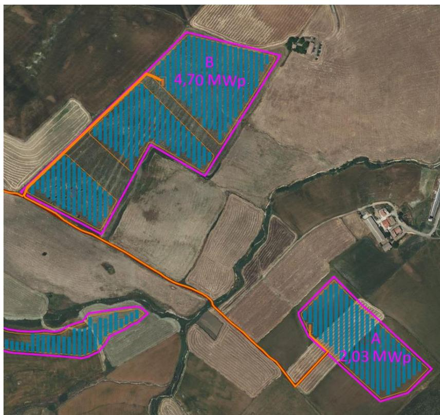
Figura 15 - Collegamento entra-esce PS Sottocampo A e Sottocampo B
