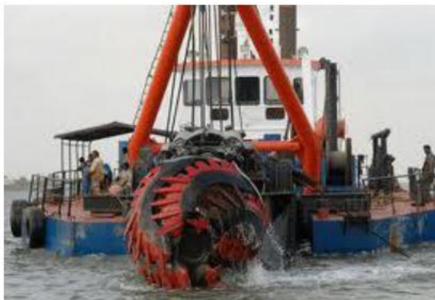
Figura 3.43 – Esempio di draga aspirante stazionaria con disgregatore (cutter suction dredgers – CSD)
