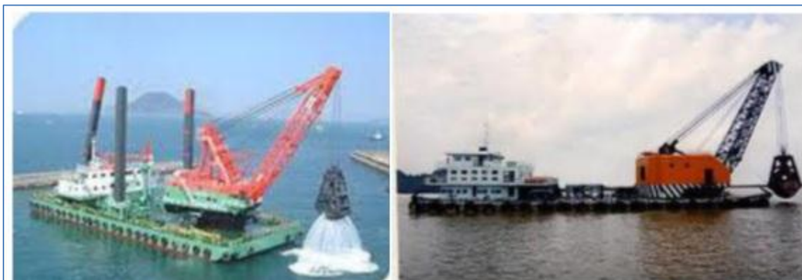
Figura 3.41 - Esempi di draghe a benna mordente o a grappo (grab dredgers – GD)
