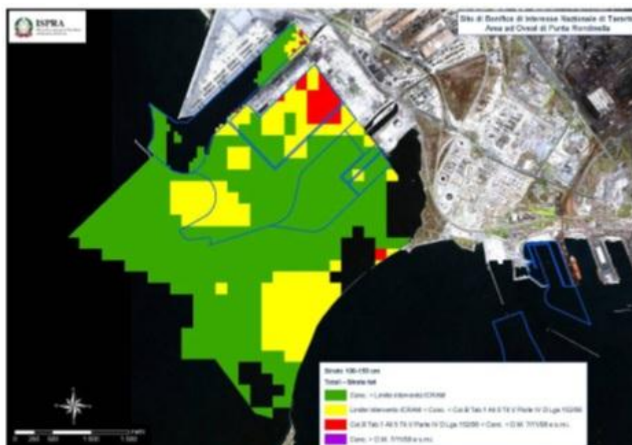
Figura 3.49 - Visualizzazione dei superamenti totali in Area Ovest Punta Rondinella relativi alla strato 100-150 cm (fonte PGS-ISPRA 2009)
