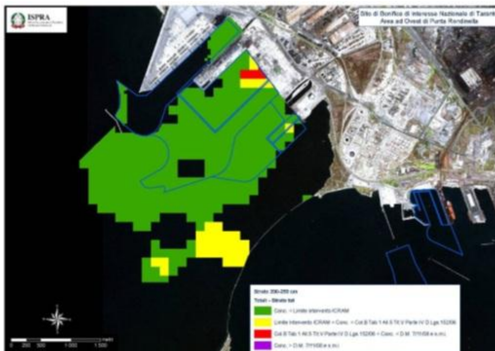
Figura 3.51 - Visualizzazione dei superamenti totali in Area Ovest Punta Rondinella relativi alla strato 200-250 cm (fonte PGS-ISPRA 2009)
