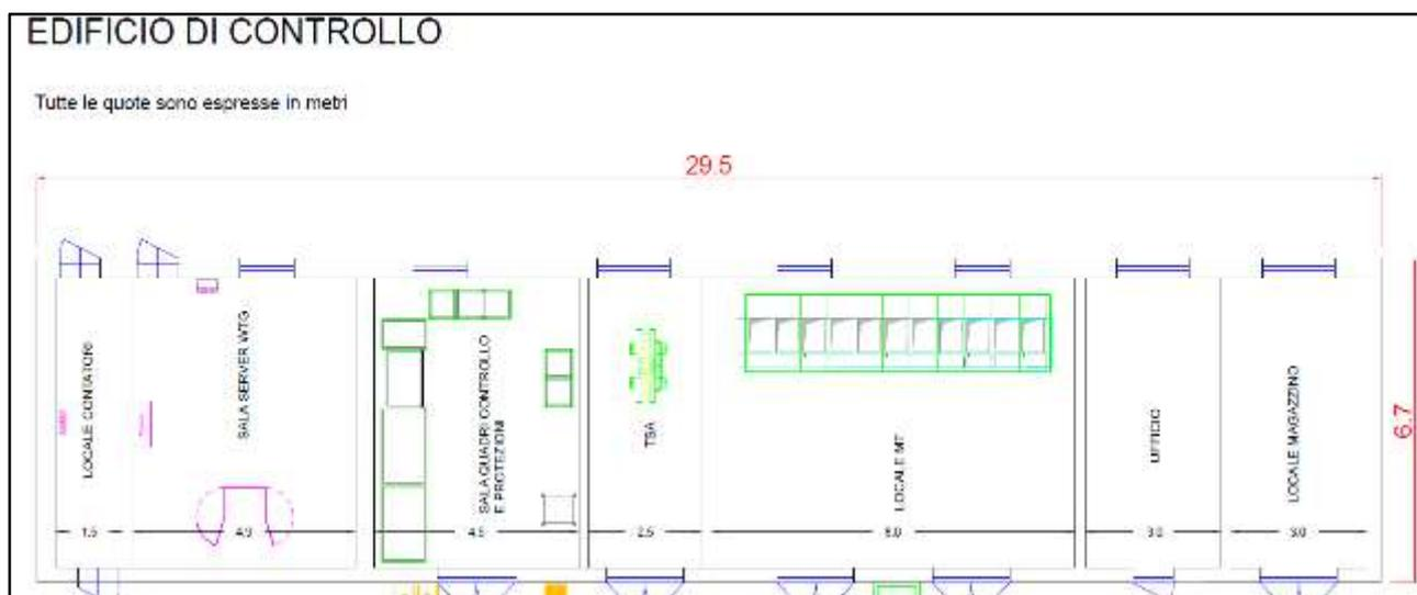
**Figura 2.3.2.4:** Pianta edificio di controllo SEU 150/33 kV
