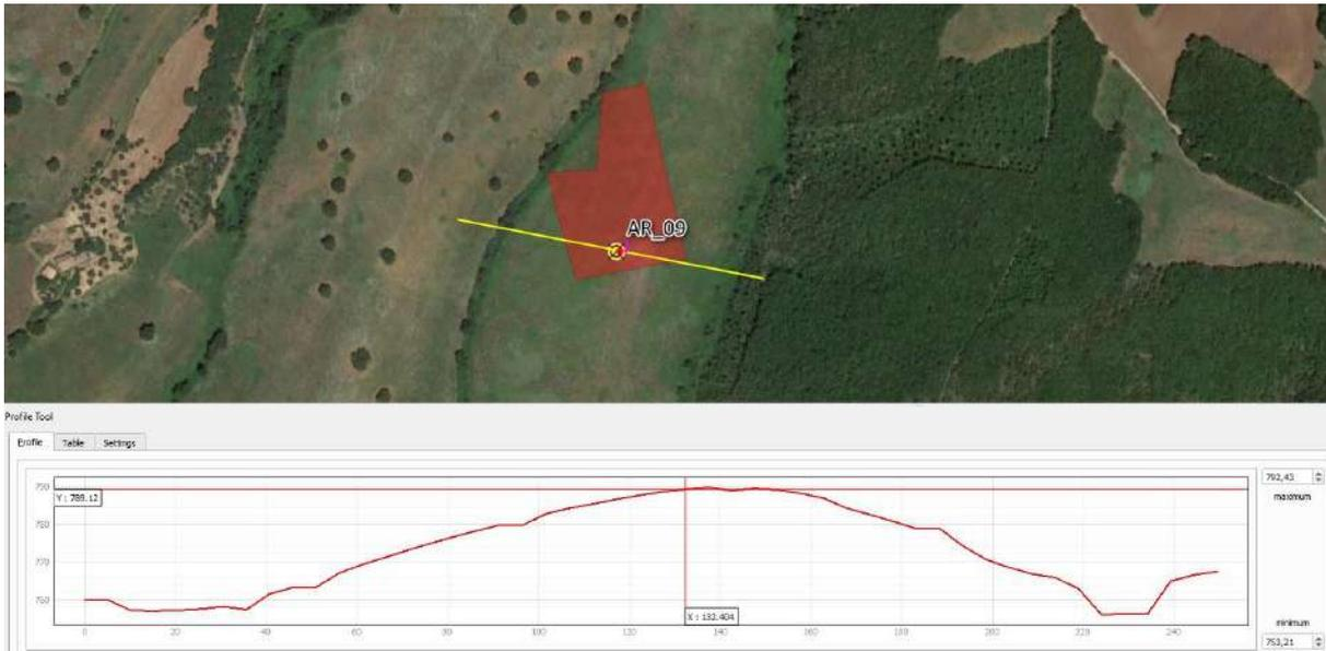
L'area di sedime dell'aerogeneratore AR\_09 è ubicata in località San Biagio, alla quota di 790,0 metri s.l.m., nella porzione alta del versante esposto a Sud-Ovest facente parte della dorsale con andamento Nord-Ovest Sud-Est che suddivide il bacino del Fosso del Cerrito (ad Ovest) e il Vallone dell'Acqua Fredda (a Est).
