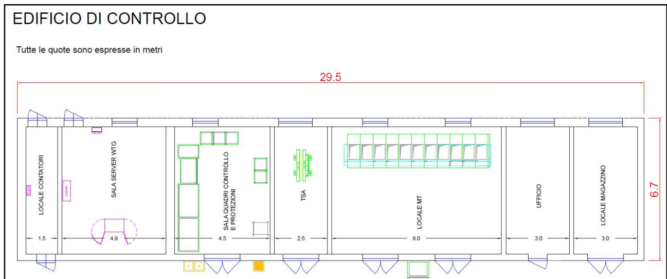
Figura 2.3.2.4: Pianta edificio di controllo SEU 150/33 kV
