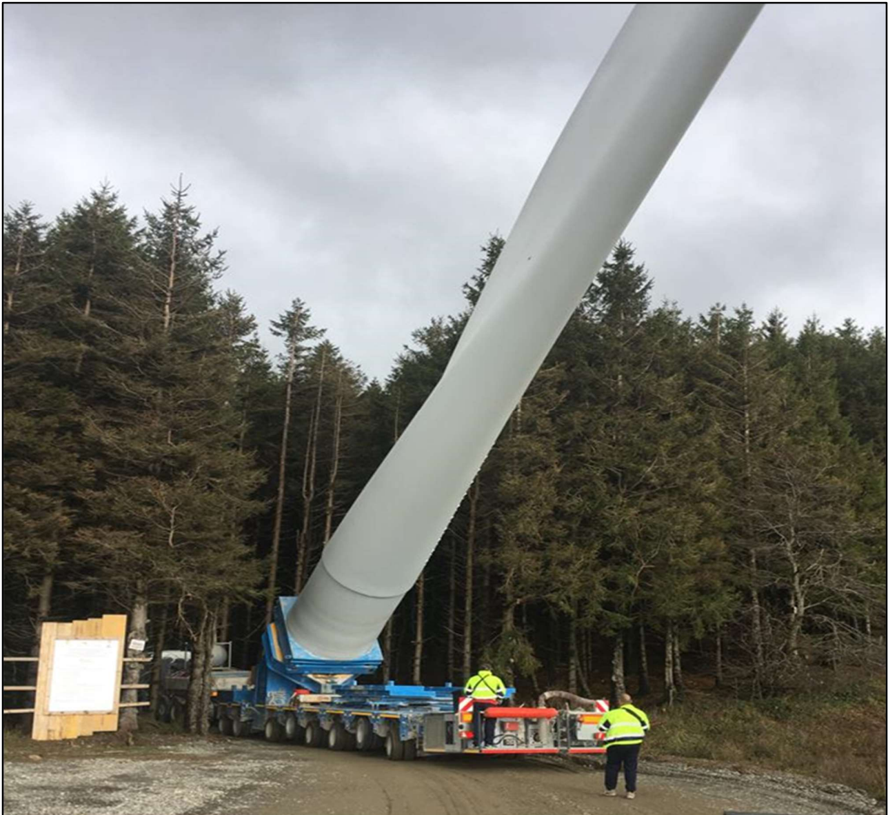
Figura 4.3: Trasporto con “Blade Lifter”
