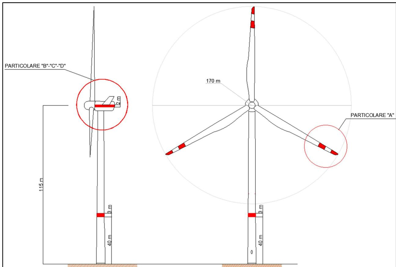
Figura 4.1: Profilo aerogeneratore SG170 – 6,2 MWp – HH= 115 m – D=170 m
