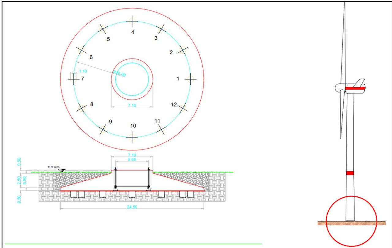
**Figura 5.1:** Fondazioni tipo per l'installazione degli aerogeneratori
