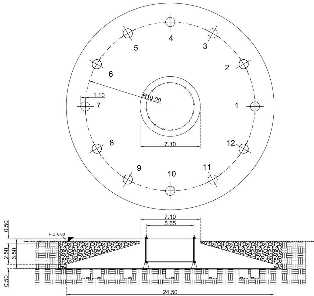
Figura 5.1.1: Dettaglio pianta e sezione fondazione
