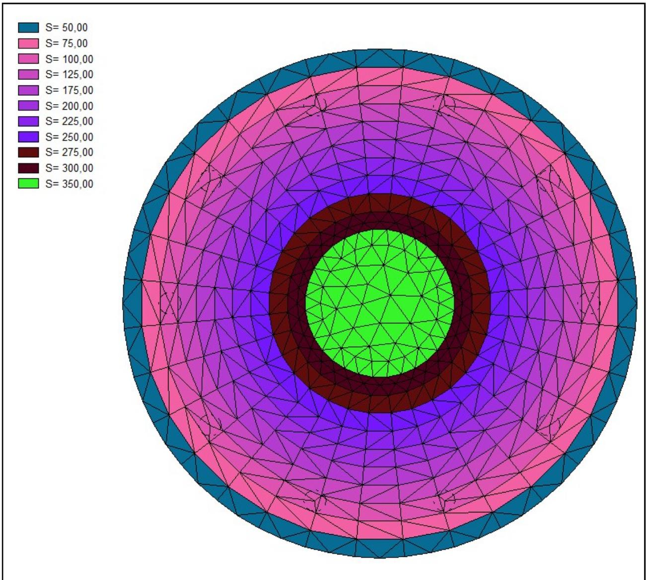
**Figura 9.1.1:** Spessori modellazione strutturale (*unità di misura cm*)
