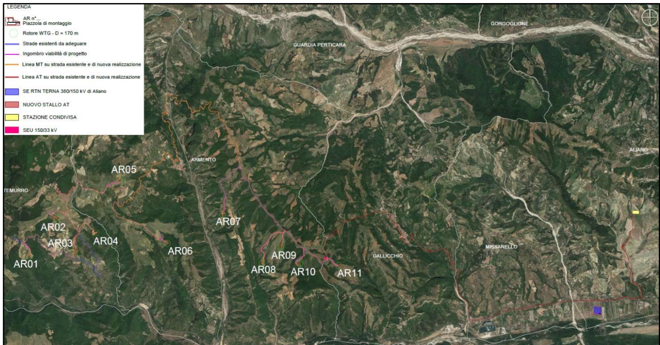
Figura 4.4: Layout d'impianto con viabilità di progetto, strade esistenti o di nuova realizzazione, linee elettriche a 33 kV, linee a 150 kV, SEU 150/33 kV, stazione condivisa e SE 380/150 kV di Aliano su Ortofoto
