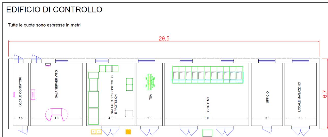
**Figura 2.3.2.4:** Pianta edificio di controllo SEU 150/33 kV
