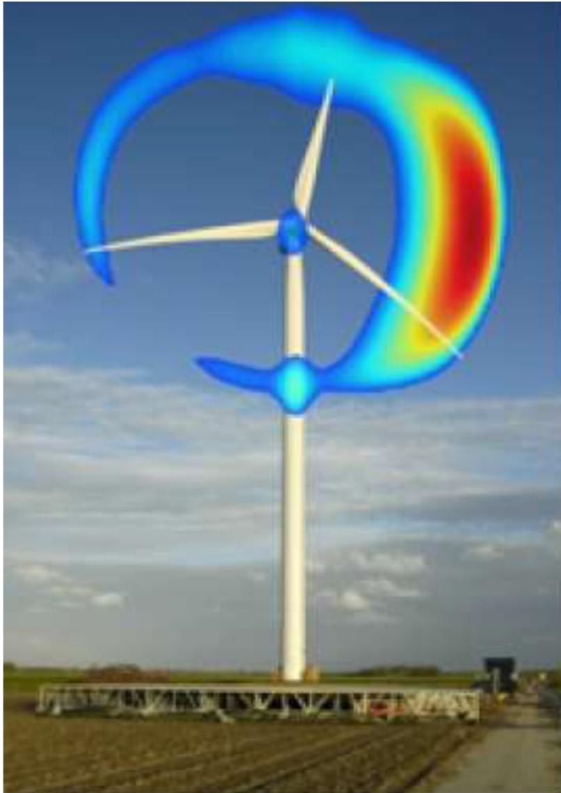
Rumore rilevato con SISTEMA BEAMFORMING
