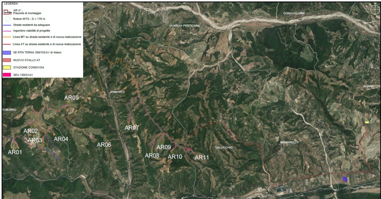
Figura 3.4: Layout d'impianto con viabilità di progetto, strade esistenti o di nuova realizzazione, linee elettriche a 33 kV, linee a 150 kV, SEU 150/33 kV, stazione condivisa e SE 380/150 kV di Aliano su Ortofoto
