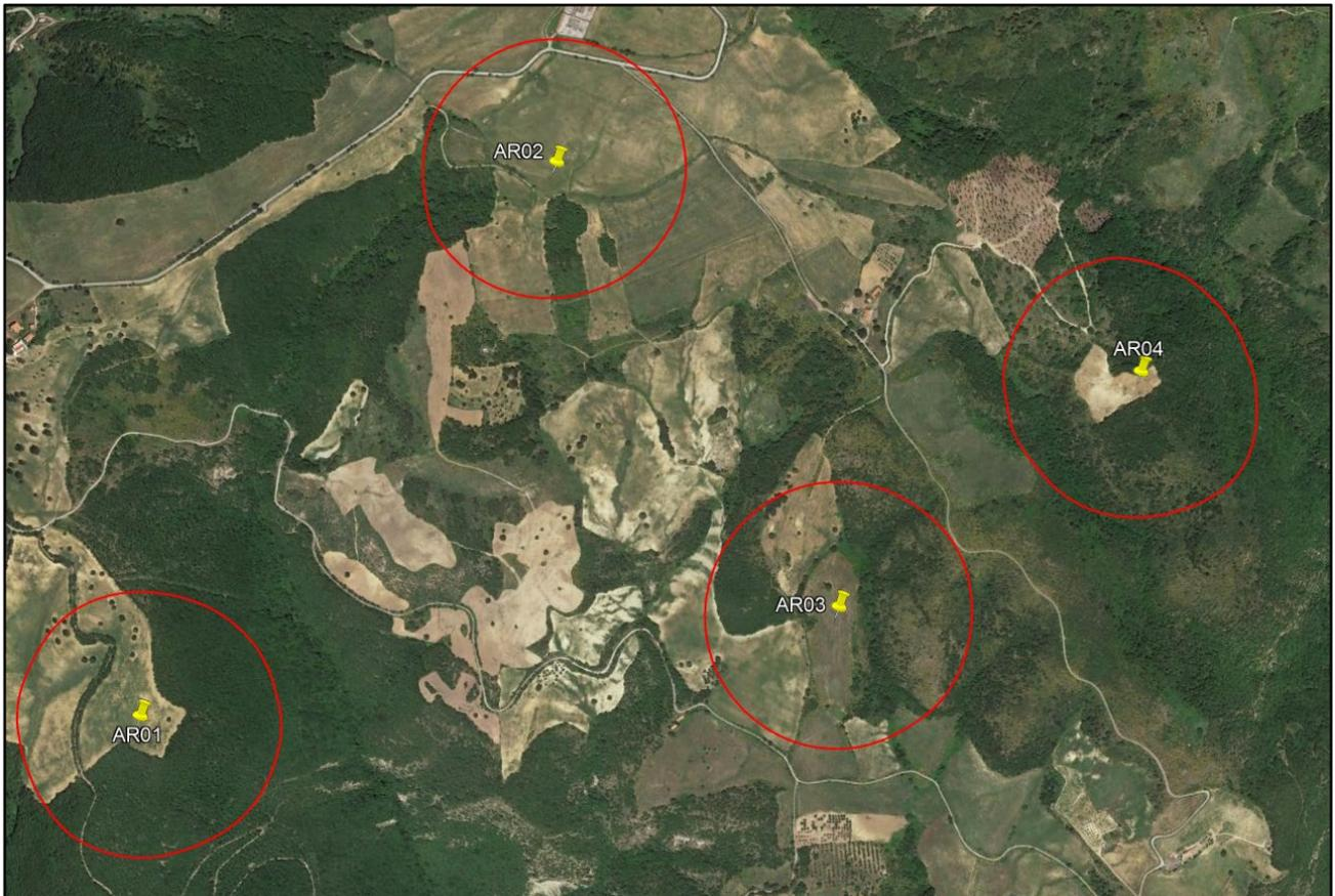
**Figura 9.1:** Aree interessate dalla rottura della pala relativamente agli aerogeneratori AR01, AR02, AR03 e AR04
