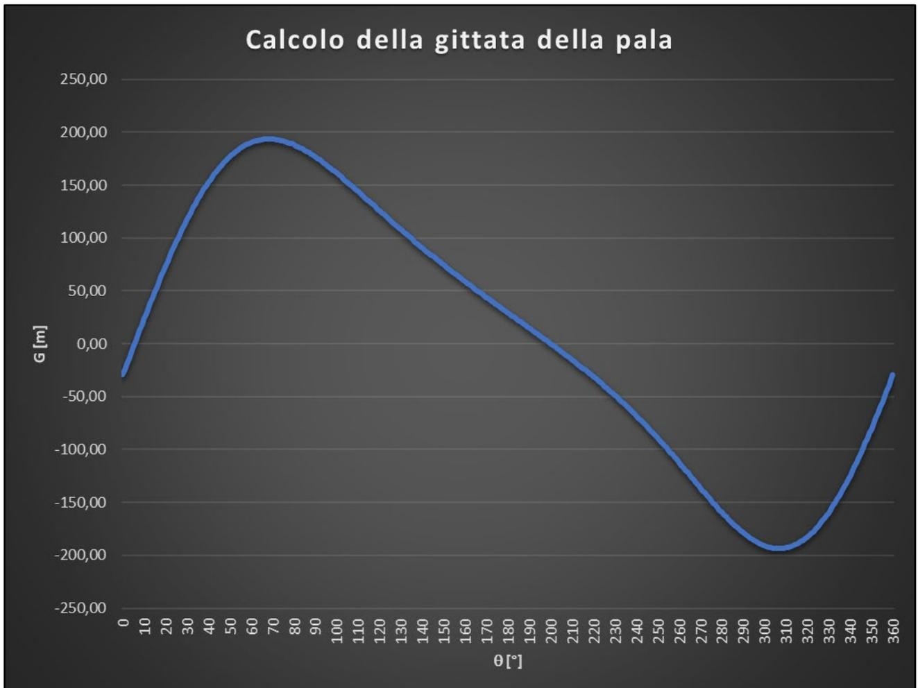
**Figura 7.2:** Rappresentazione grafica della gittata della pala nelle ipotesi specificate
