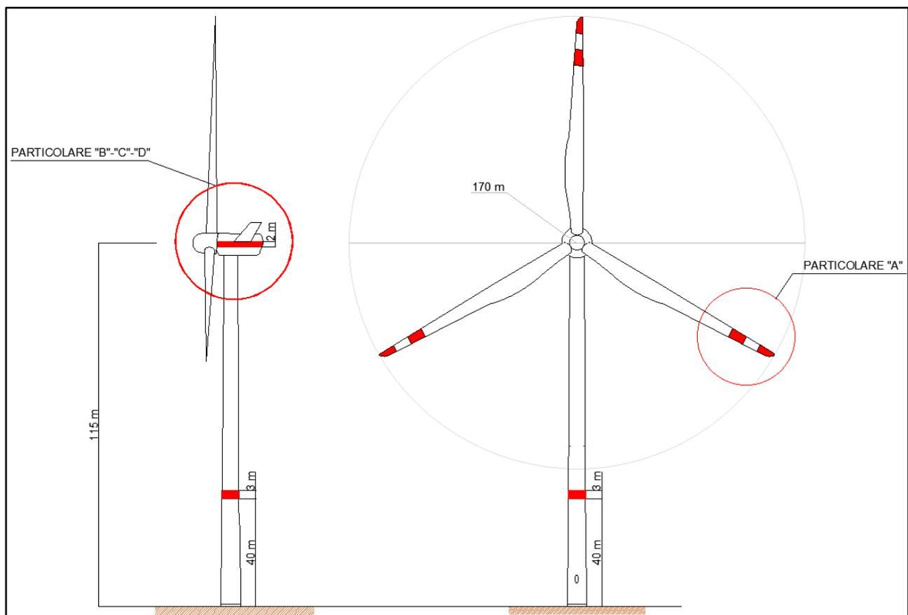
**Figura 2.1.1:** Profilo aerogeneratore SG170 da 6,2 MWp
