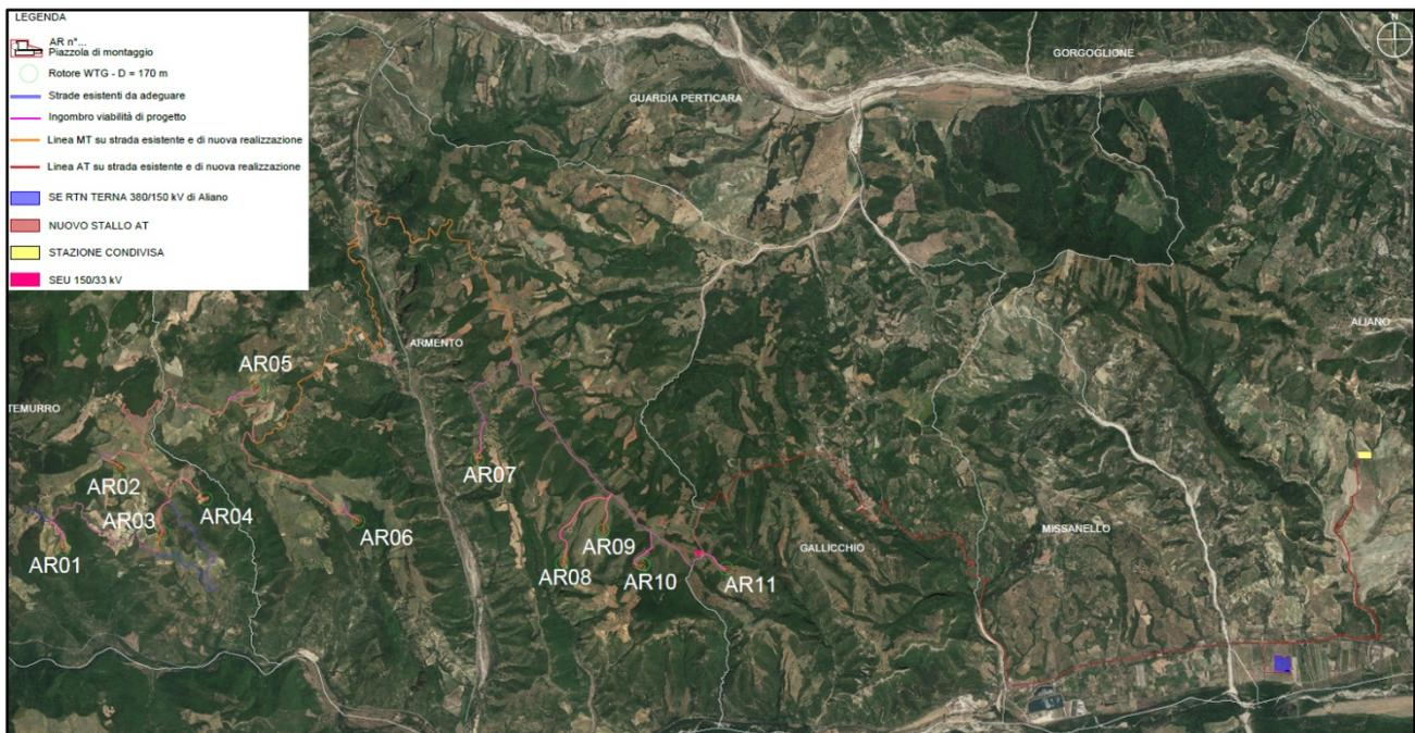
Figura 2.4: Layout dell'impianto eolico con aerogeneratori, SEU 150/36 kV e SE 380/150 kV su Ortofoto
