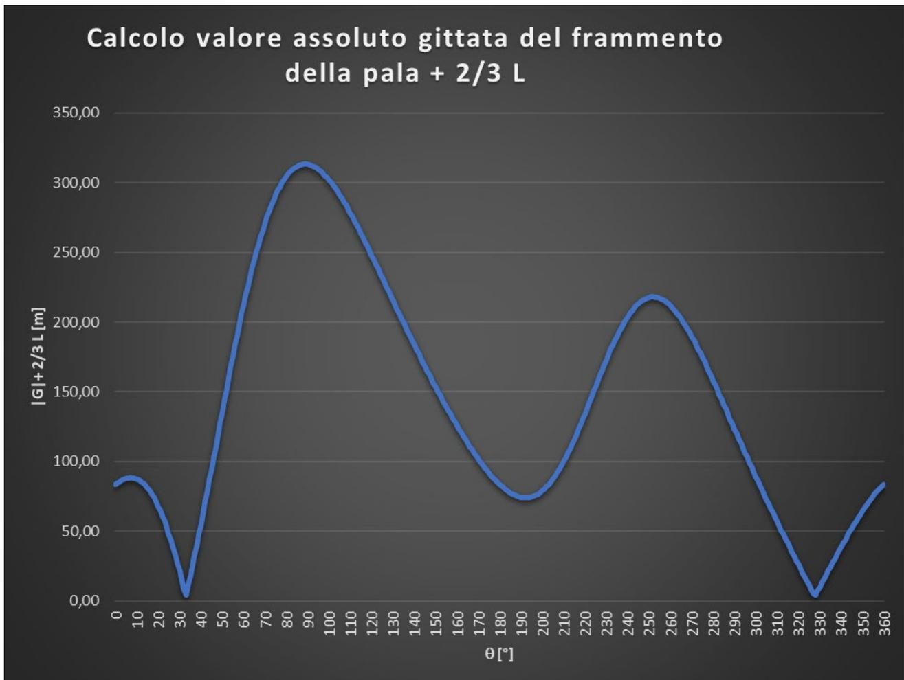
**Figura 8.2:** Grafico del valore assoluto della gittata del frammento della pala di lunghezza  $5m + 2/3 L_{FRAMMENTO}$
