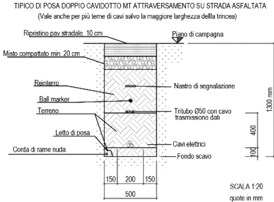
Figura 30 Tipico posa cavidotto su strada asfaltata -1 terna
