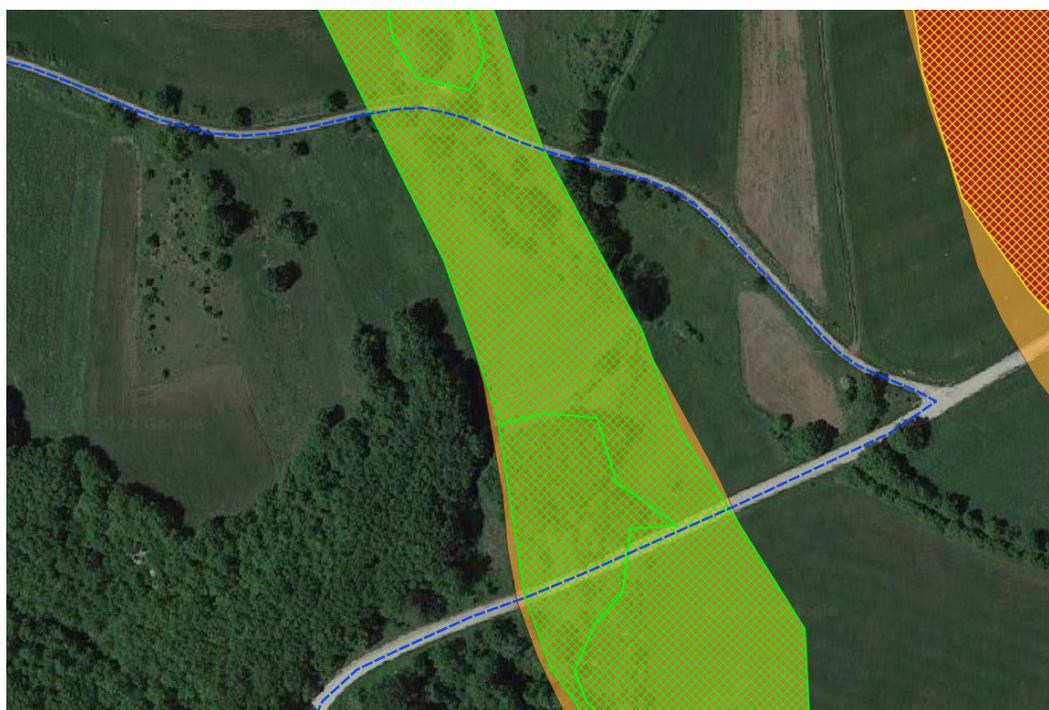
Figura 17 – Particolare su ortofoto dell'attraversamento del cavidotto su strade esistenti interferenti con le aree perimetrare dal PAI
