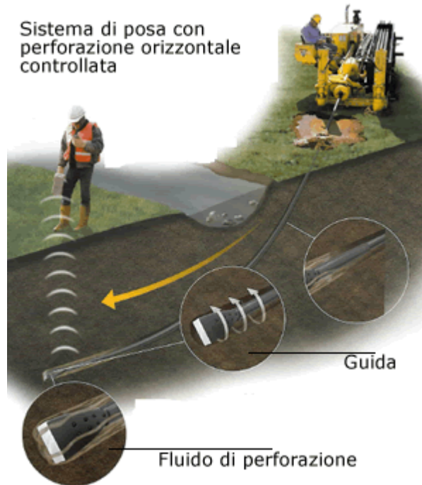
Figure 11-Sistema di trivellazione orizzontale controllata (T.O.C.).
