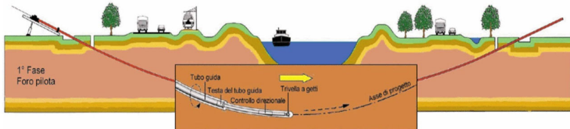
Figure 12 – Schema della fase di realizzazione del foro pilota.
