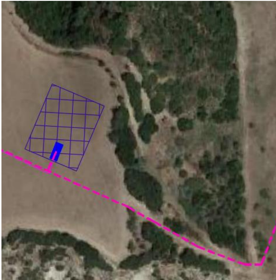
Figura 9 - Posizionamento cabina di raccolta su stralcio ortofoto
