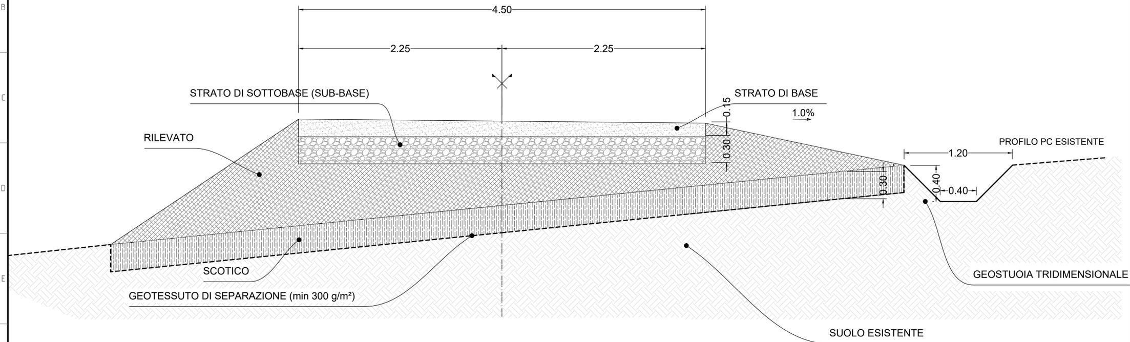
SEZIONE TIPICA VIABILITA' DA REALIZZARE IN SCAVO
