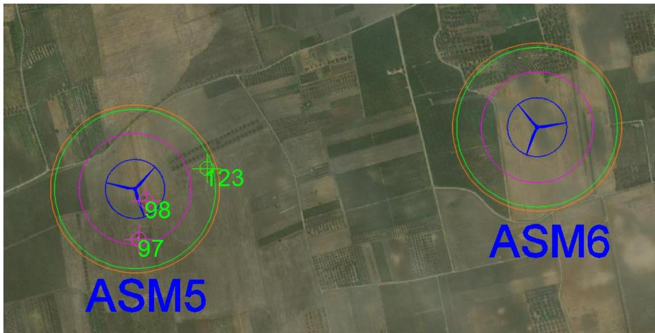
Figura 2: Individuazione planimetrica dei ricettori nel buffer di 160 metri per la pala intera (MAGENTA), 230 m per il frammento di 10 metri (VERDE) e 242 metri per il frammento da 5 metri (ARANCIONE)
