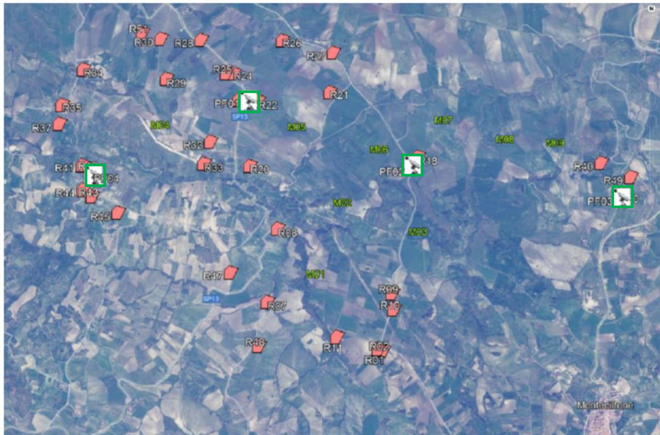
Figura 3: Vista di insieme di tutta l'area di studio con evidenza delle turbine di progetto (in verde con la sigla MXX) e dei recettori sensibili o fabbricati individuati e indicati in arancio con la dicitura "RXX". In verde sono riquadrate le postazioni fonometriche, indicate con la sigla PF.
