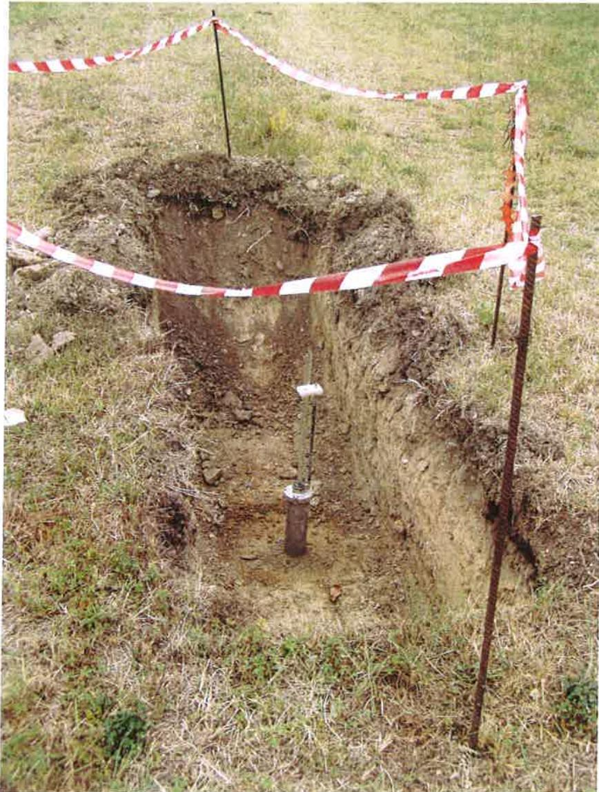
Foto n.6: Vista della Trincea esplorativa T3 con il relativo permeametro per l'esecuzione della prova in sito P5.
