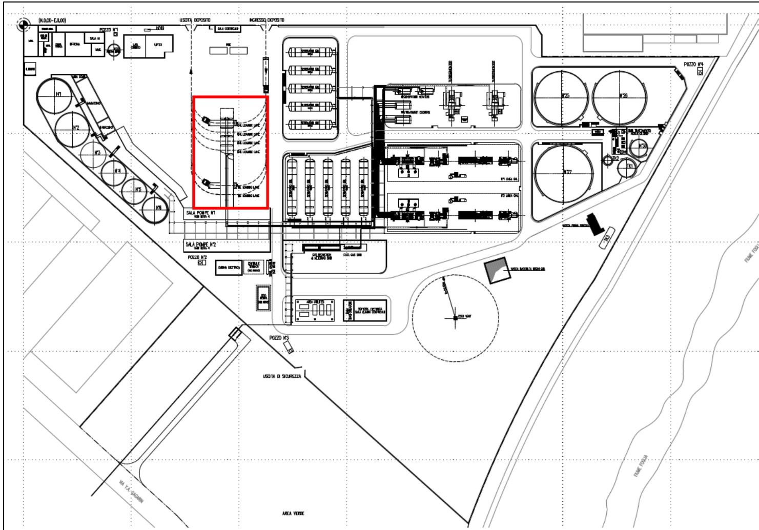
Figura 1 - Posizione pensiline di carico nel Deposito Costiero di Pesaro
