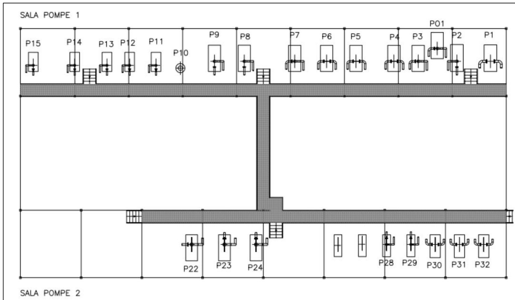
Figura 2 - Posizione elettropompe nel Deposito Costiero di Pesaro – Sala Pompe no.1 e no.2
