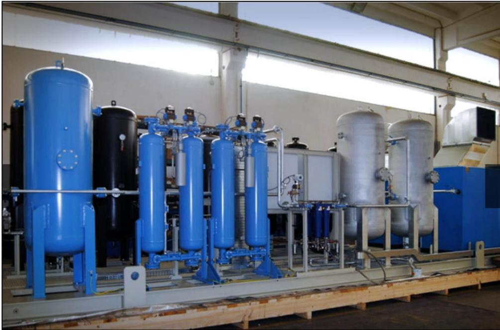
Per rendere disponibili tali servizi si parte dall'aria atmosferica: dei compressori comprimono l'aria atmosferica fino a tipicamente 10-12 barg, poi questa viene filtrata ed essiccata tramite un apposito skid composto da riscaldatore, filtri e letti adsorbenti specifici per trattenere l'umidità dell'aria. Questi passaggi sono necessari a finché l'aria abbia un dew point sufficientemente basso per evitare di danneggiare piloti e attuatori delle valvole automatiche.
