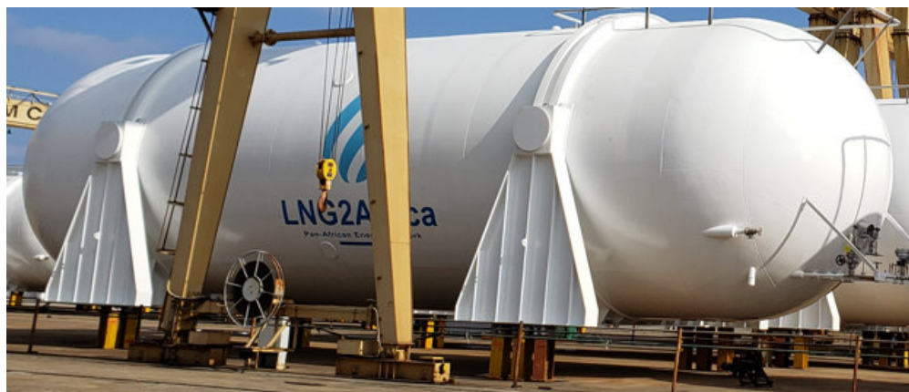
Figura 5-2 - Foto serbatoio criogenico stoccaggio LNG
