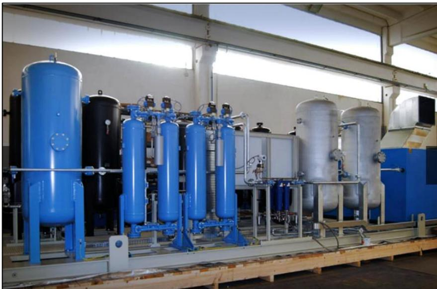
Per rendere disponibili tali servizi si parte dall'aria atmosferica: dei compressori comprimono l'aria atmosferica fino a tipicamente 10-12 barg, poi questa viene filtrata ed essiccata tramite un apposito skid composto da riscaldatore, filtri e letti adsorbenti specifici per trattenere l'umidità dell'aria. Questi passaggi sono necessari finché l'aria abbia un dew point sufficientemente basso per evitare di danneggiare piloti e attuatori delle valvole automatiche.
